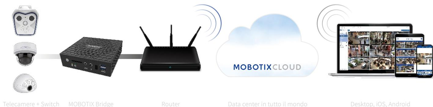
Oltre al componente hardware MOBOTIX Bridge, il MOBOTIX CLOUD include i servizi di registrazione video, salvataggio e archiviazione, accesso da remoto in tempo reale a qualsiasi telecamera, notifiche, gestione degli utenti e sicurezza Internet. Tutto ciò è compreso nel modello di abbonamento mensile.
