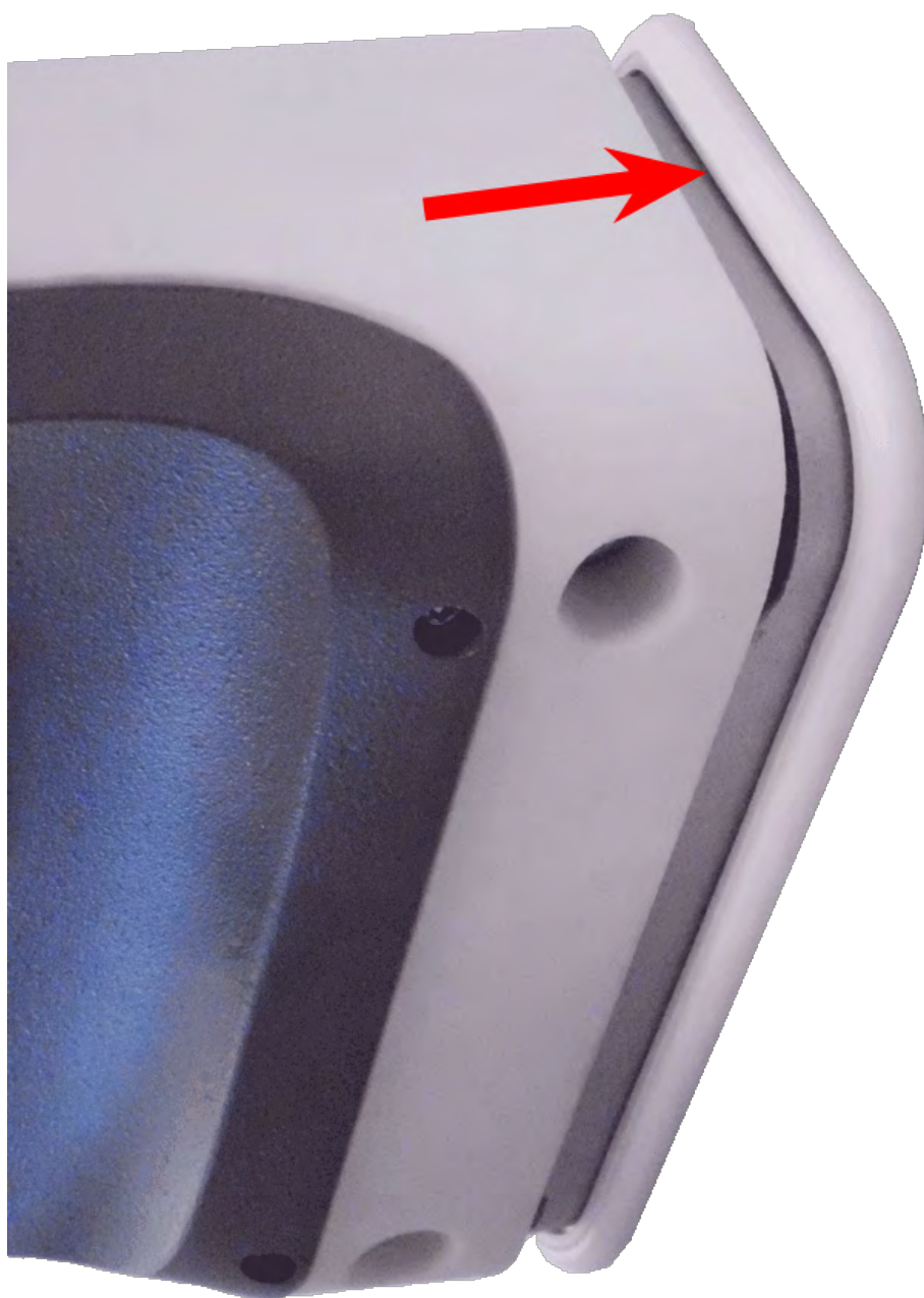
Abb. 41: Kamera auf Montageplatte drücken
