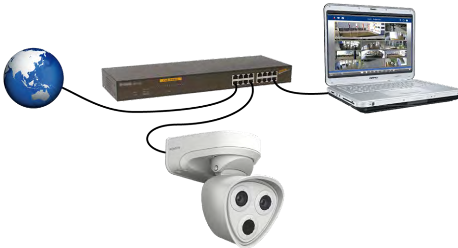
Abb. 36: Spannungsversorgung mit PoE-Switch nach PoE Plus (802.3at-2009)
