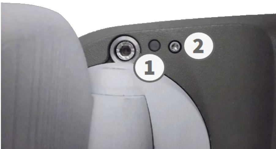
Abb. 46: Ansicht der M73 von unten mit LED (1) und Schraube mit Dichtung (2), unter der die Taste im Kameragehäuse liegt
