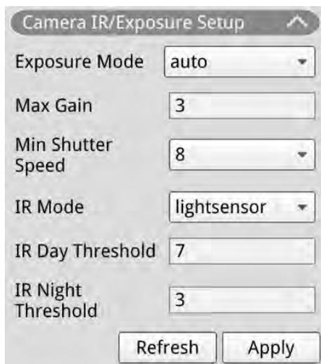
Mit dem NVR können Benutzer die IR-Funktion und die Belichtungseinstellungen der IP-Kamera konfigurieren.
