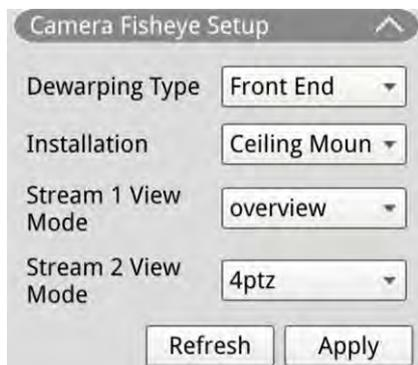
Der NVR unterstützt Dewarping-Einstellungen für Fischaugen-Kameras, je nach DSP der Kamera. Wählen Sie den Fischaugen-Kamerakanal aus und klicken Sie links auf **Kamera-Fischaugen-Einstellung**, um die Einstellungen anzuzeigen.
