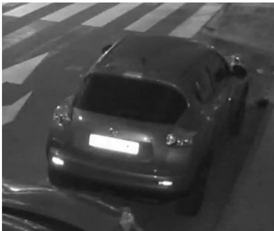
Abb. 14: Überbelichtete Kennzeichen aufgrund zu starken IR-LED-Lichts
