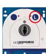
Die LED blinkt jetzt ein Mal und wiederholt dieses Blinksignal nach einer Pause von einer Sekunde (die Anzahl der Blinksignale entspricht der aktuell auswählbaren Boot-Option). Drücken Sie den Taster erneut kurz (< 1 s), um zur nächsten Boot-Option zu wechseln. Nach der letzten Boot-Option wird wieder die erste angezeigt (1 x blinken).
