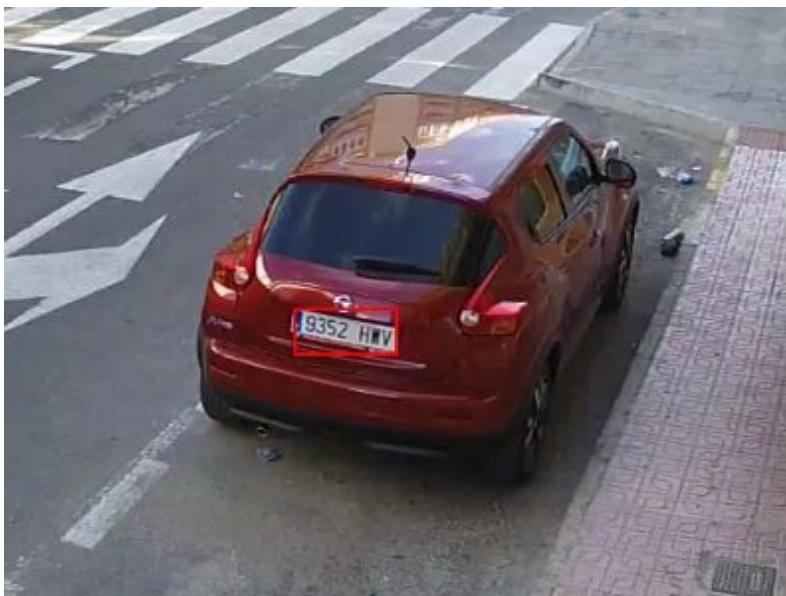
Fig. 16: Unzureichende Lichtverhältnisse zur Erkennung des Kennzeichens
