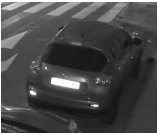
Fig. 14: Überbelichtete Kennzeichen aufgrund zu starken IR-LED-Lichts
