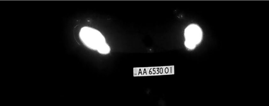
Gut lesbares Kennzeichen bei Nacht mit Infrarot-LED-Beleuchtung
