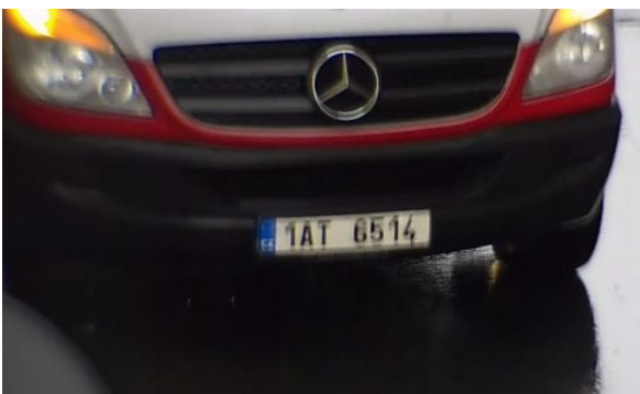
Fig. 12: Unscharfes Kennzeichen aufgrund langer Belichtungszeit
