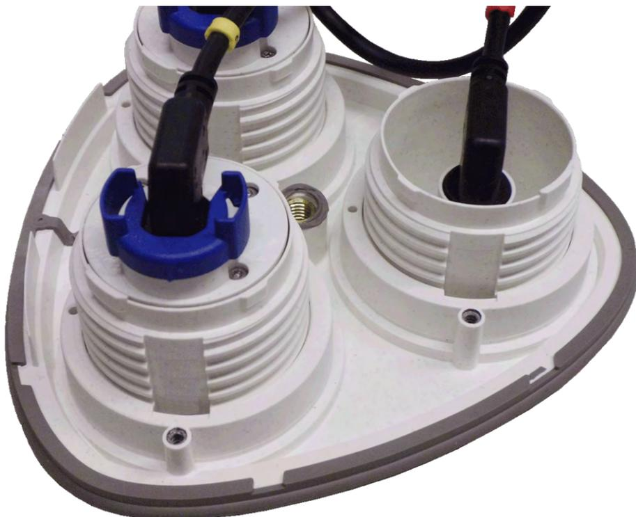
Abb. 15: Standardfrontplatte mit Sensormodulen (Rückseite)
