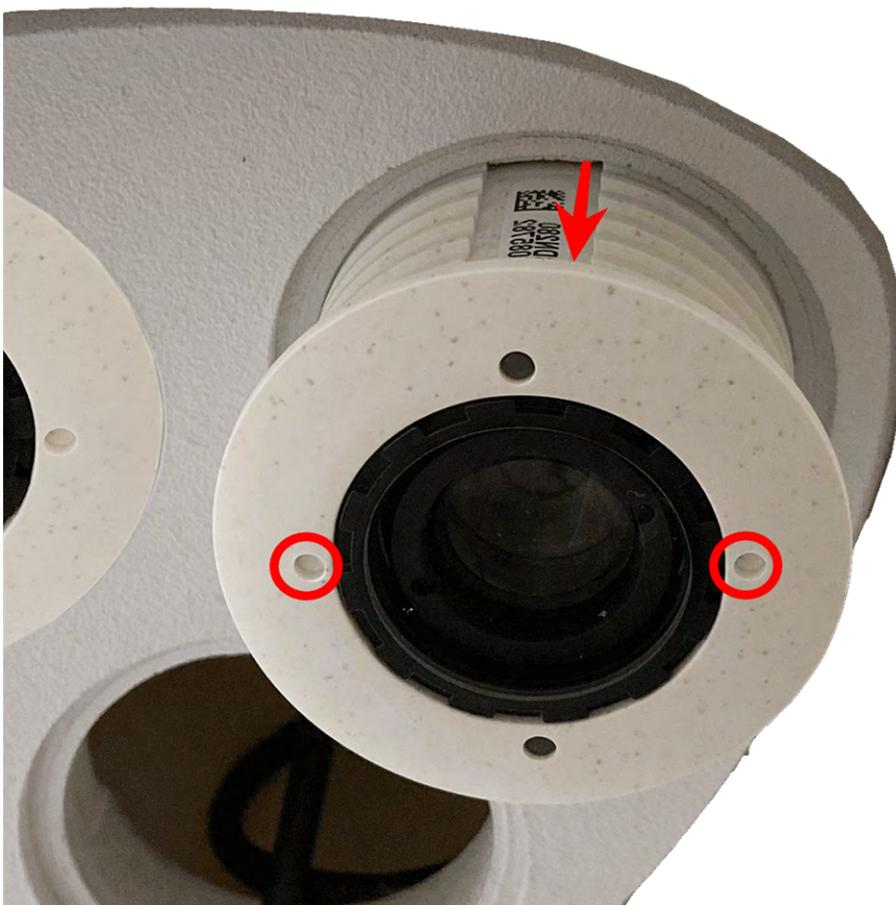
Abb. 25: Entfernen des Sensormoduls aus dem Modulgehäuse
