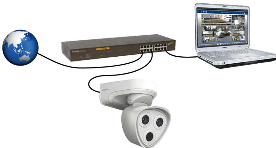
Abb. 36: Spannungsversorgung mit PoE-Switch nach PoE Plus (802.3at-2009)
