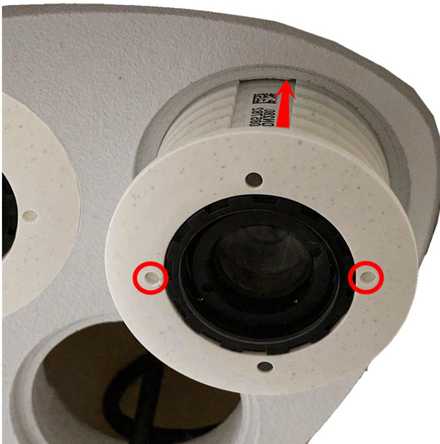
Abb. 27: Sensormodul in Thermal-Frontplatte einsetzen
