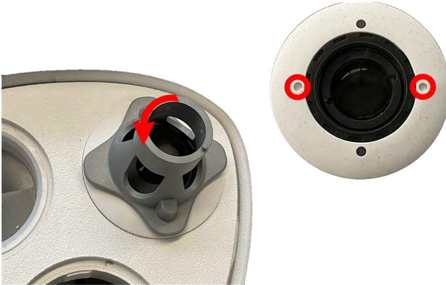
Abb. 24: Sensormodul entriegeln
