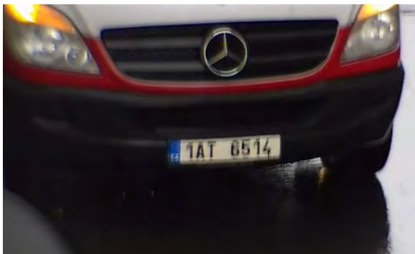
Abb. 12: Unscharfes Kennzeichen aufgrund langer Belichtungszeit
