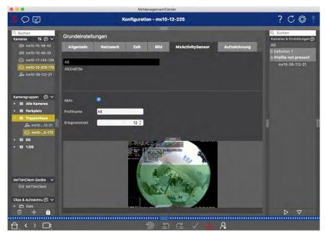
Fig. 57: The MxActivitySensor
