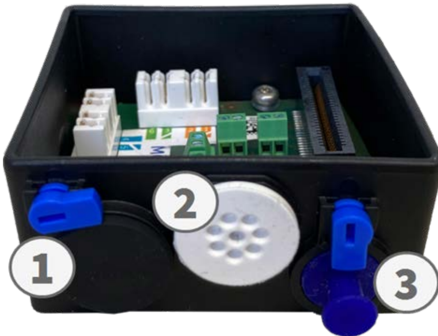
Abb. 56: Anschlussbox LSA mit Gummistopfen, schwarz C.3 (1); Gummistopfen einadrig C.4 (2); USB-Stecker (3) und zwei blauen Verriegelungen
