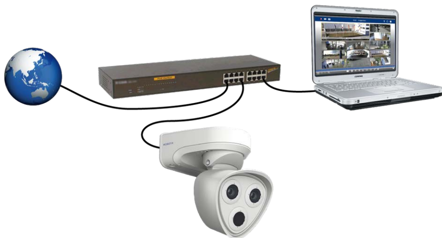
Abb. 52: Stromversorgung per PoE-Switch gemäß PoE Plus (802.3at-2009)
