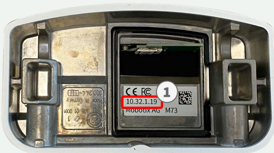
Abb. 5: IP-Adresse auf der Rückseite des Kameragehäuses
