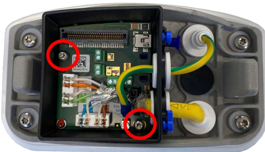
Abb. 67: Anschlussbox LSA (Draufsicht) mit zwei Schrauben (rot hervorgehoben) an Montageplatte montieren
