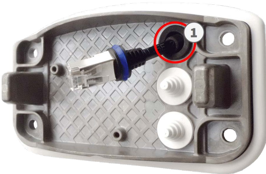
Abb. 33: Montageplatte vorbereitet für Anschlussbox RJ45
