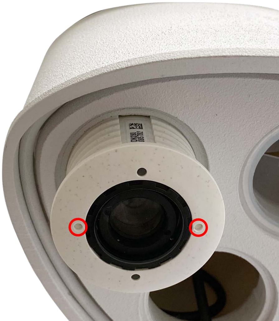
Abb. 12: Sensormodul in Modulgehäuse einsetzen
