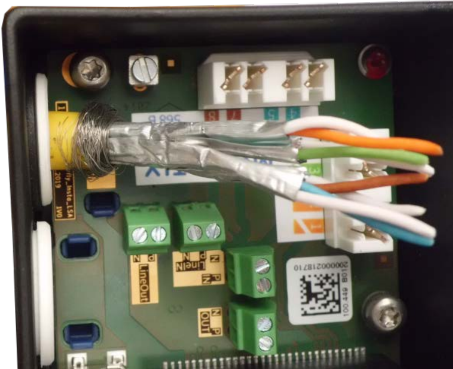
Abb. 60: Netzkabel eingesteckt, Stopfen richtig eingesetzt
