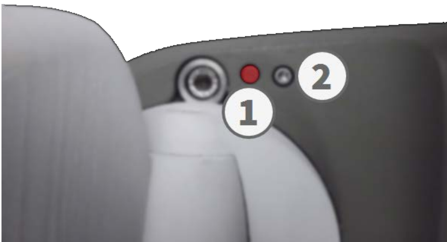
Abb. 74: Ansicht der M73 von unten mit LED (1) und Schraube mit Dichtung (2), die die Taste im Kameragehäuse verbirgt
