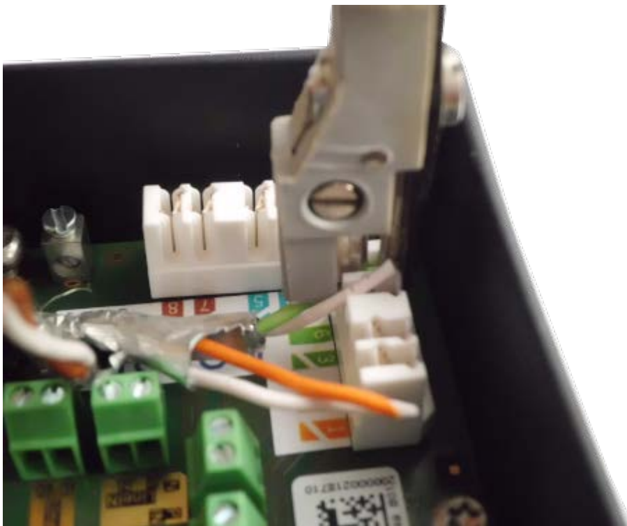
Abb. 63: Mit Krone LSA-Plus-Anlegewerkzeug angeschlossenes Netzkabel
