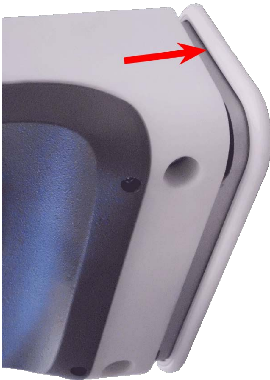
Abb. 69: Kamera auf Montageplatte drücken
