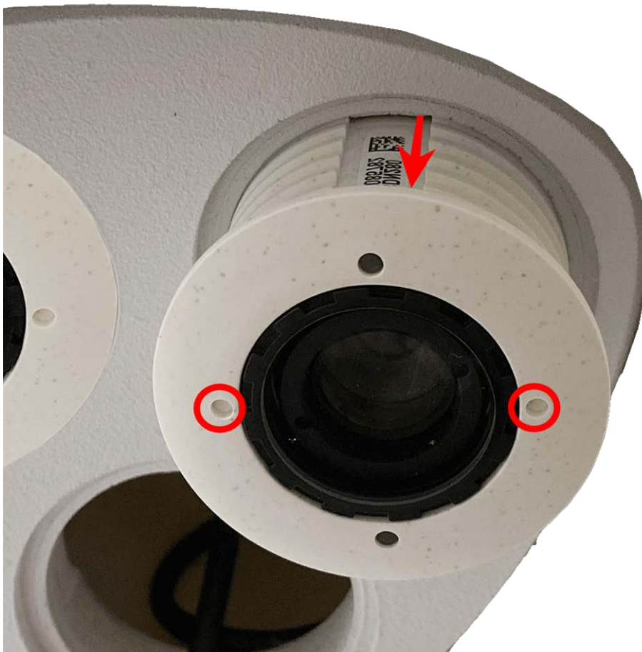
Abb. 23: Sensormodul aus Modulgehäuse entfernen
