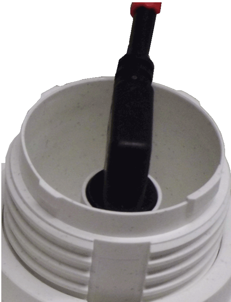
Abb. 10: Rückseite des Blindmoduls mit angeschlossenem Steckverbinder
