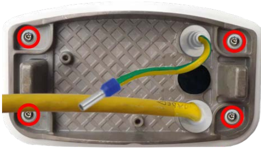
Abb. 58: Montageplatte mit Masseleitung und Netzkabel
