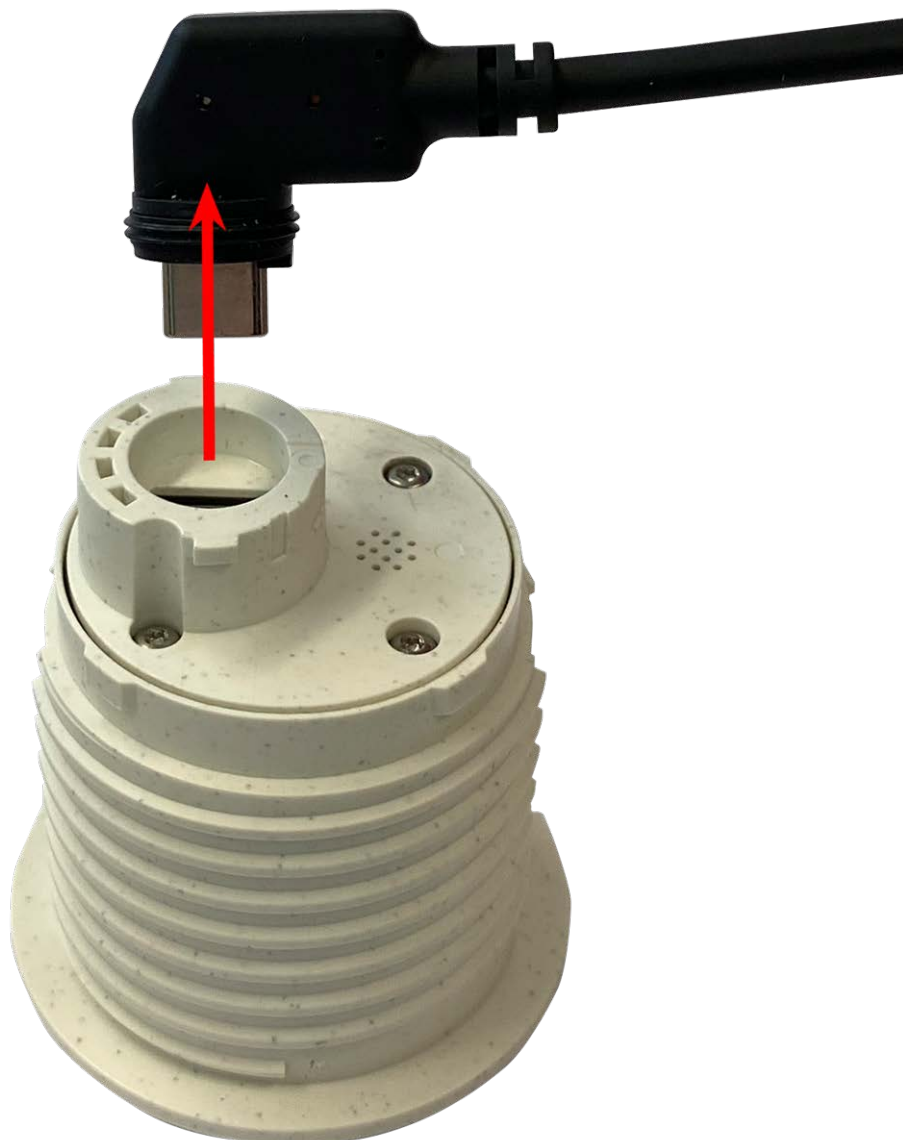
Fig. 21: Remove the sensor module cable
