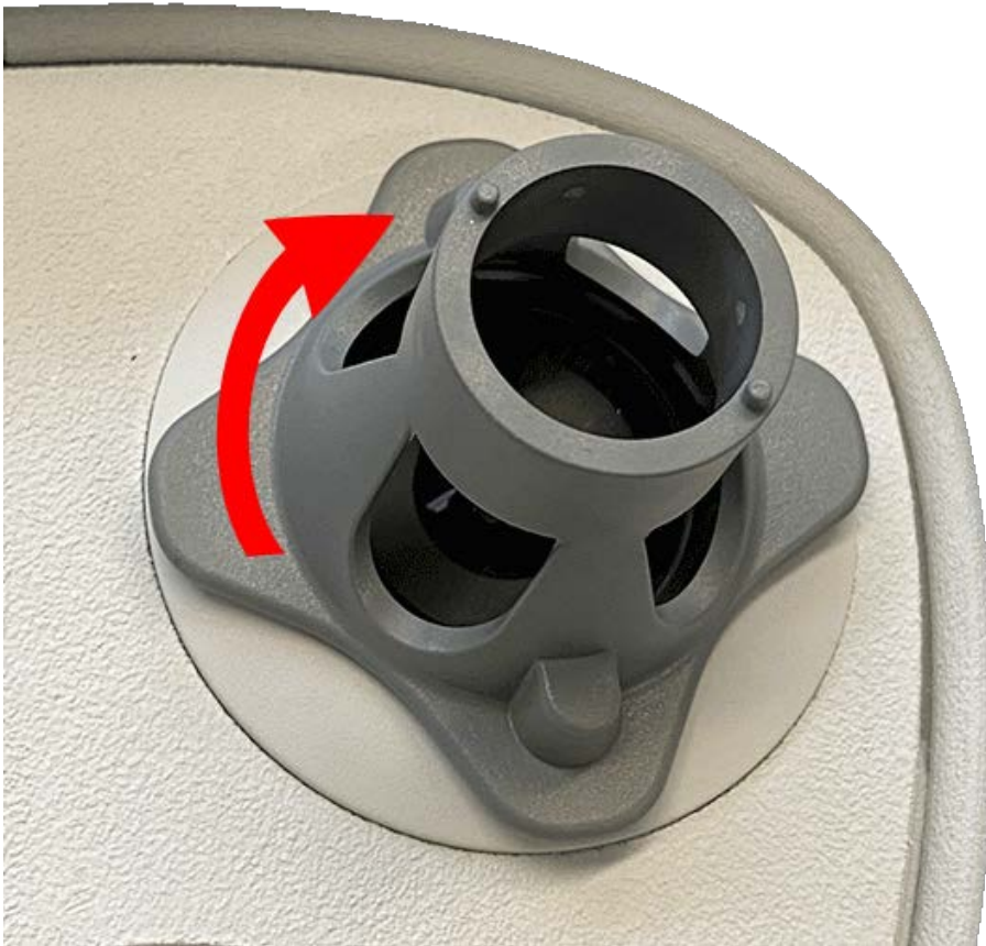
Fig. 26: Lock the sensor module
