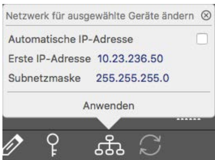
Fig. 80: Change network settings for selected devices (Modifier les paramètres réseau pour les périphériques sélectionnés)
