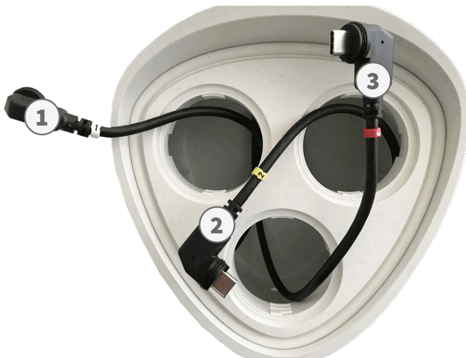
Fig. 8: Câbles du module de capteur numérotés
