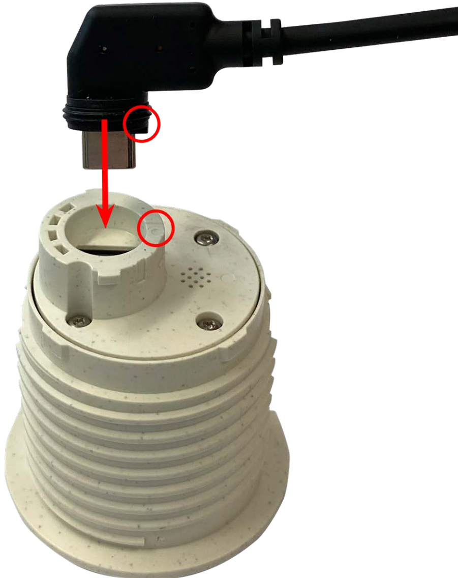
Fig. 9: Branchez le câble du module de capteur
