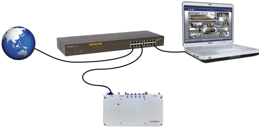
Abb. 23: Stromversorgung über PoE-Switch gemäß PoE Plus (802.3at-2009)
