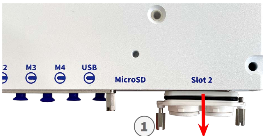
Abb. 18: Entfernen der Abdeckung vom Steckplatz der Schnittstellenkarte
