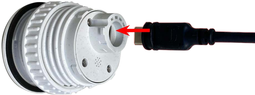
Abb. 11: Anschließen des Sensormodulkabels
