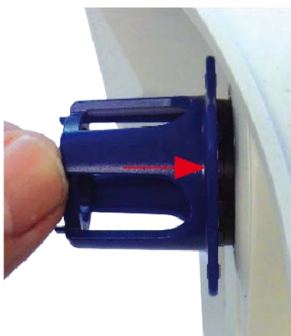
Fig. 37: Appuyez fermement pour insérer le verre de protection de l'objectif et tournez pour le verrouiller
