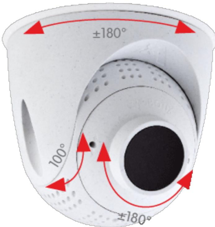
7. Assurez-vous que l'étiquette **MOBOTIX** de l'insert est orientée vers le haut. Si ce n'est pas le cas, desserrez les deux vis de fixation à l'aide de la clé Allen de 2 mm et faites tourner l'insert. Serrez légèrement les deux vis de fixation.
