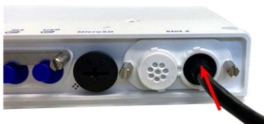
Fig. 24: Appuyez fermement sur la fiche jusqu'à ce que la bague d'étanchéité bleue s'enclenche
