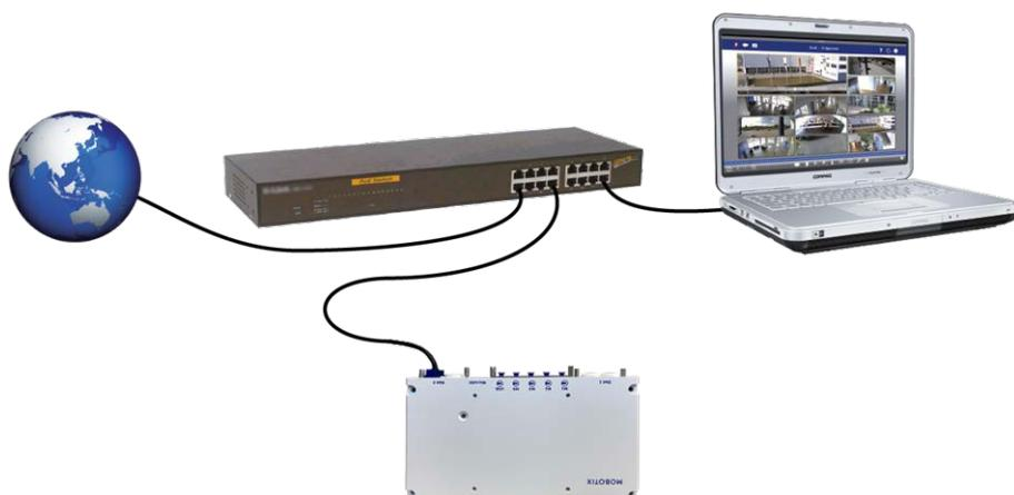
Fig. 23: Alimentation électrique à l'aide d'un commutateur PoE conformément à PoE Plus (802.3at-2009)
