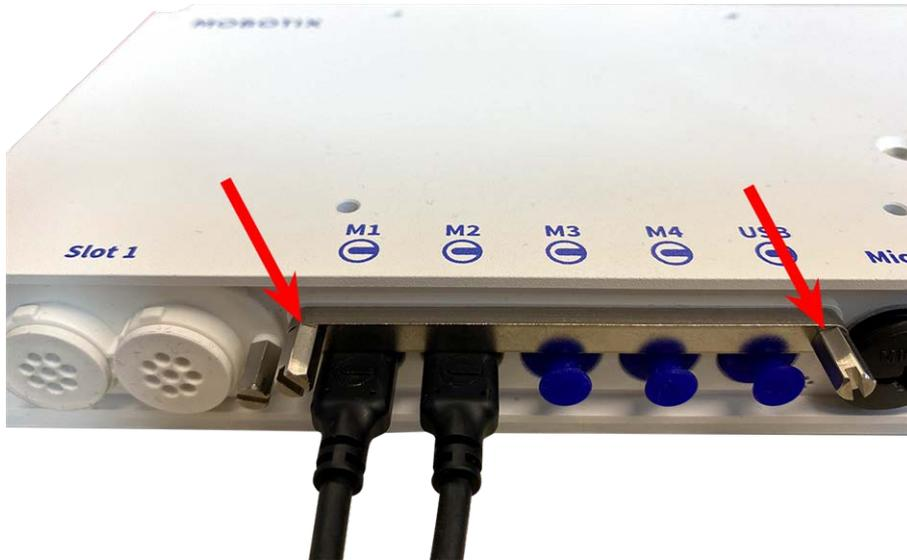
Fig. 21: Ports de connecteurs de modules
