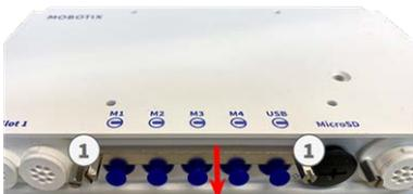
2. Déposez le bouchon en caoutchouc bleu (1) du connecteur de module.
