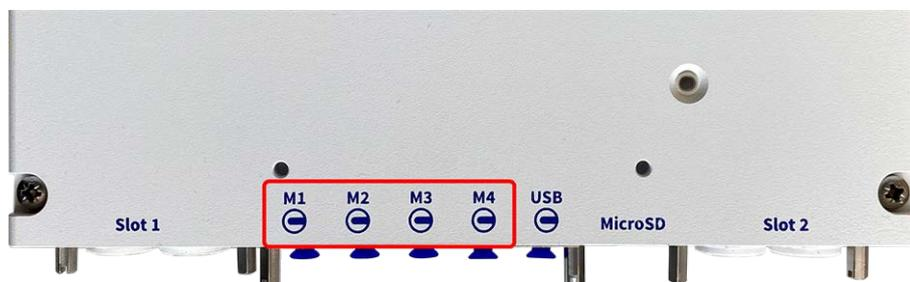
Fig. 22: Connecteurs de modules de la S74
