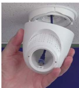
6. Utilisez les deux vis pour fixer l'ensemble pied et sphère à la bague rotative, en veillant à ce que le pied continue de pivoter.
