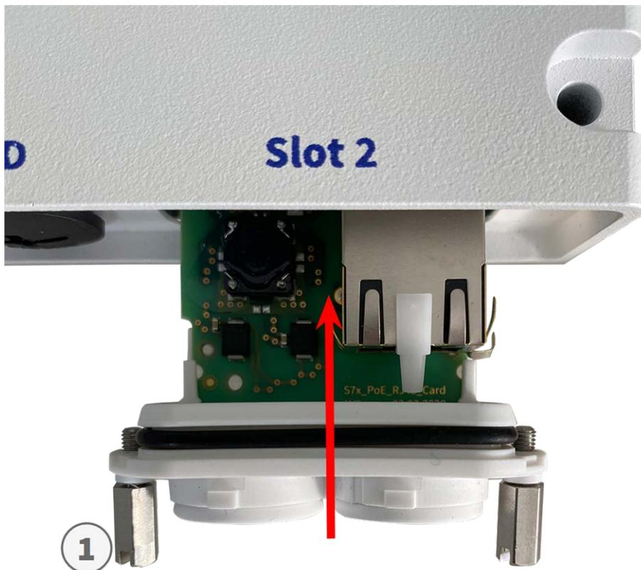
Fig. 19: Connexion de la carte d'interface RJ45
