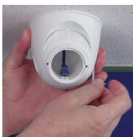
7. Desserrez les deux vis de fixation de l'insert (1), puis faites tourner l'insert de sorte que la petite barre située à l'opposé de l'étiquette **TOP/OBEN** soit orientée vers le trou de la vis sans tête (2).
