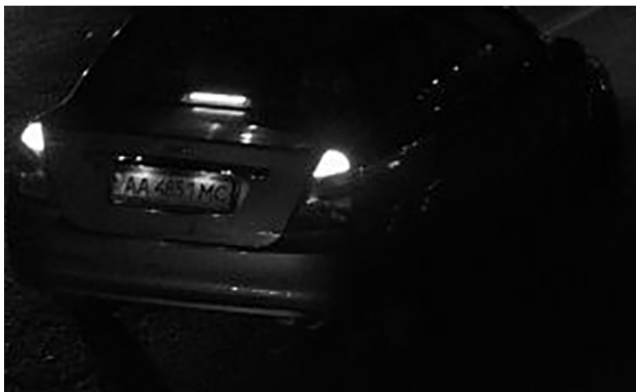
Fig. 15: L'éclairage est trop faible pour reconnaître la plaque d'immatriculation
