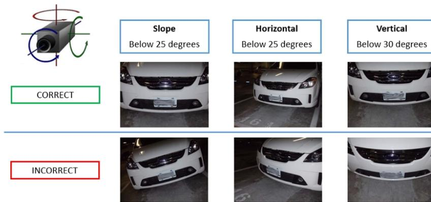
Fig. 10: Angle de rotation maximal
