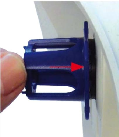
**Fig. 87: Presione fuerte para insertar el cristal de protección del objetivo y gire para bloquearlo**
