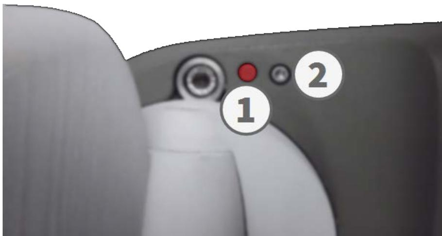
Fig. 74: Vista del M73 desde abajo con el LED (1) y el tornillo con sellado (2) que oculta la llave dentro del chasis de la cámara
