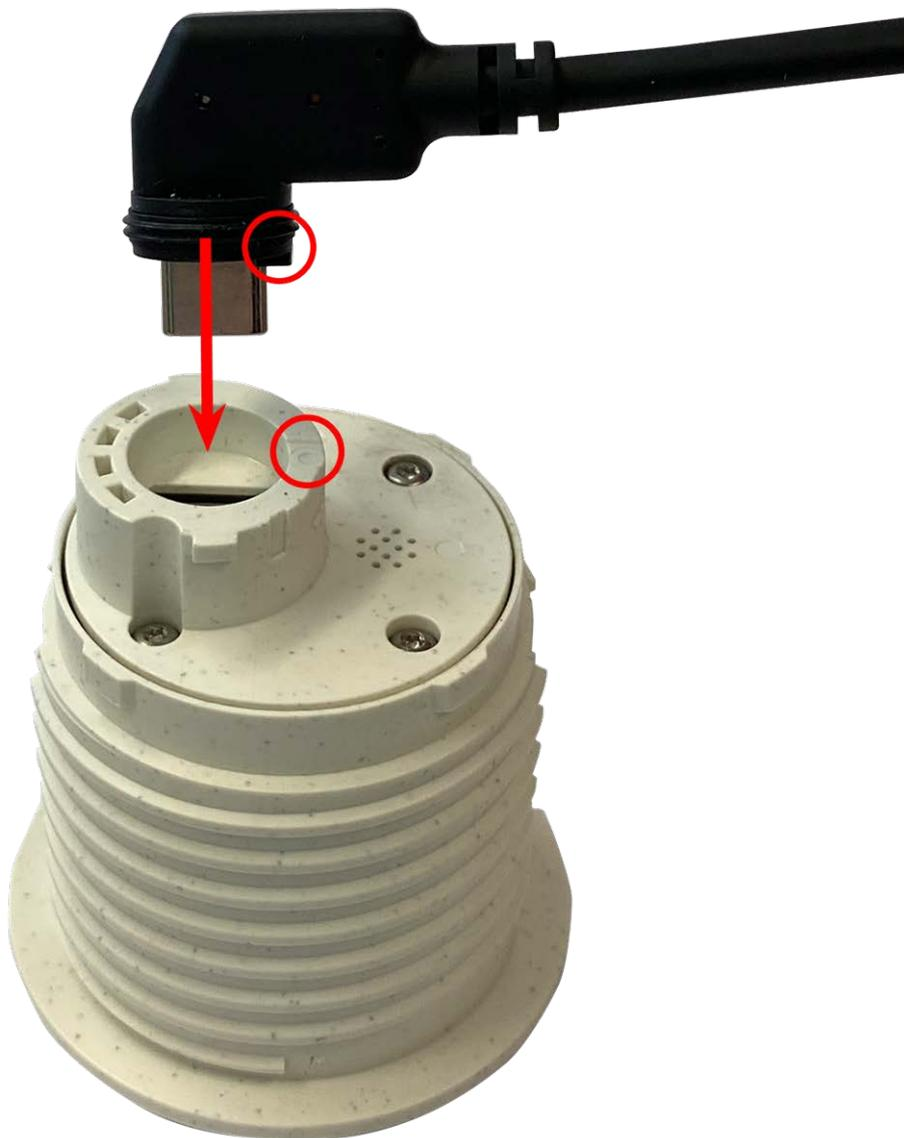
**Fig. 9: Conecte el cable del módulo de sensor**
