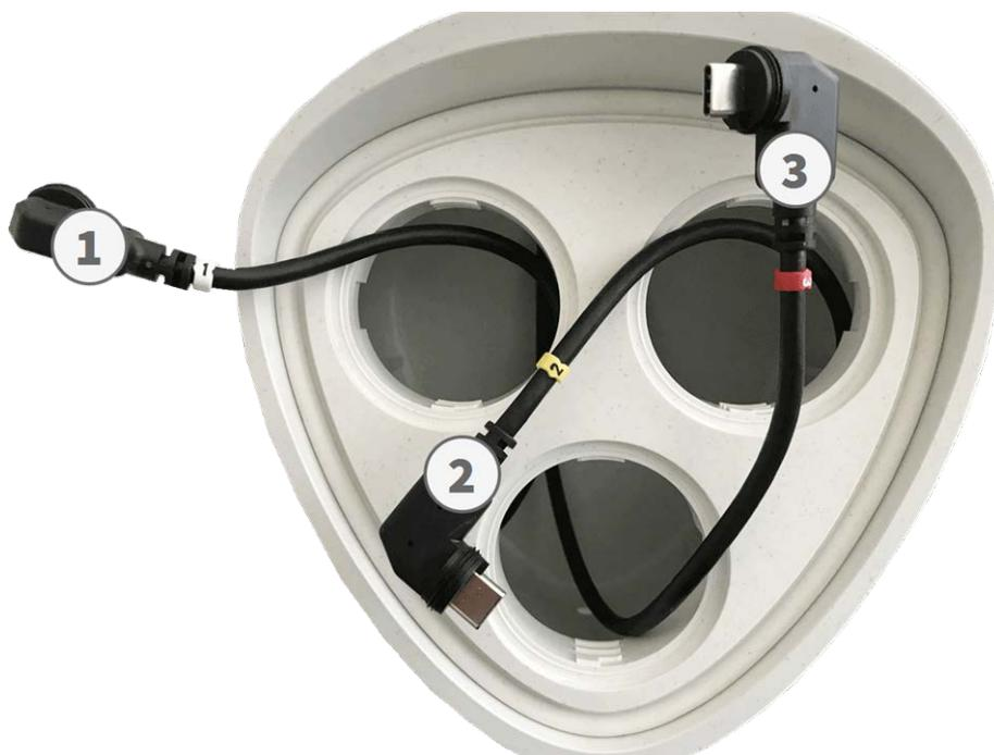
Fig. 8: Cables del módulo de sensor numerados
