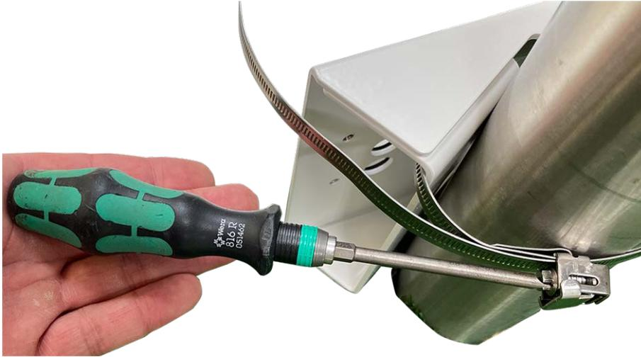
Fig. 42: Ajuste de las correas
