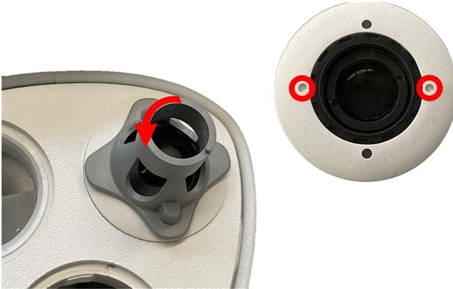
Fig. 22: Desbloqueo del módulo de sensor
