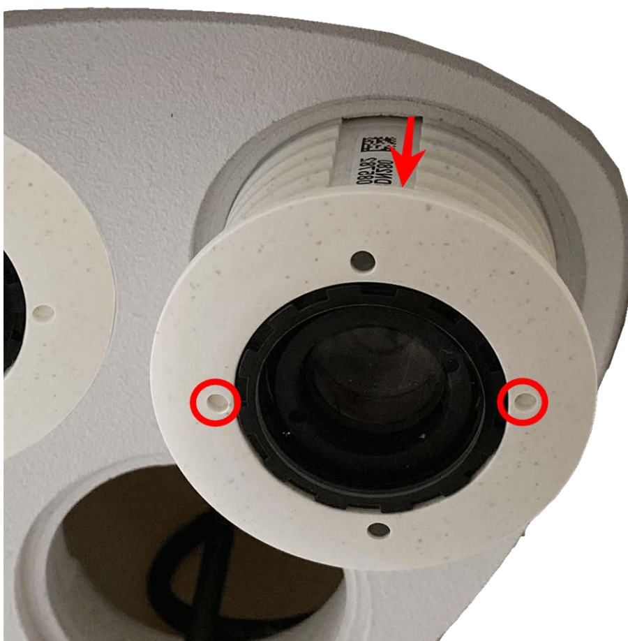
Fig. 23: Rimuovere il modulo sensore dall'alloggiamento del modulo
