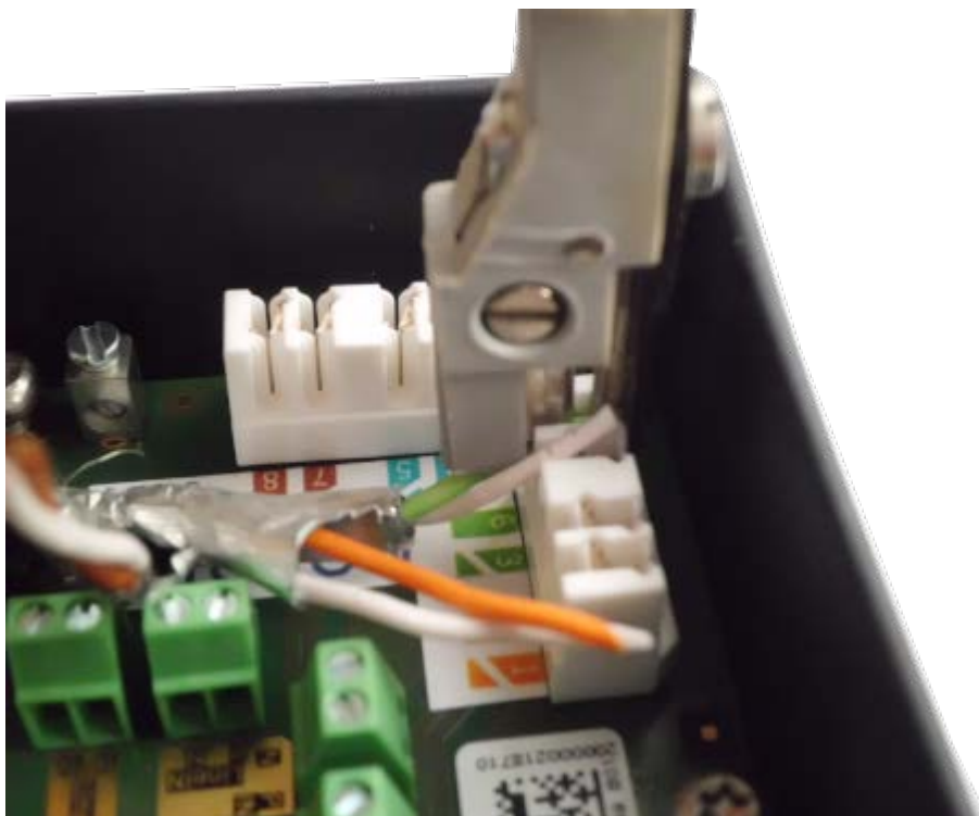
Fig. 63: Fili del cavo di rete collegati mediante lo strumento LSA+/Krone
