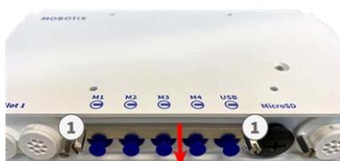
2. Retire el tapón de caucho azul (1) del conector del módulo.
