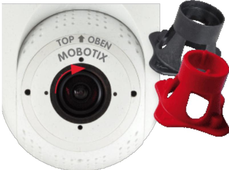
11. Fije el módulo de sensor apretando el tornillo prisionero con la llave Allen de 2,5 mm. El tornillo prisionero bloquea el módulo de sensor dentro de la pieza y evita el desbloqueo accidental del módulo de sensor.
