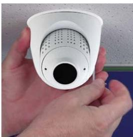
6. Ajuste el módulo de sensor temporalmente apuntando hacia la dirección de visualización deseada.
