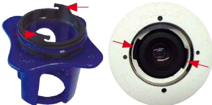
Abb. 36: Einsetzen des Schutzglases mit dem Linsenschlüssel
