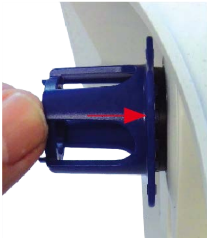
Abb. 37: Drücken Sie fest, um das Schutzglas einzusetzen, und drehen Sie es, um es zu verriegeln.
