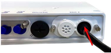
Abb. 24: Drücken Sie den Stecker fest ein, bis der blaue Dichtring einrastet.
