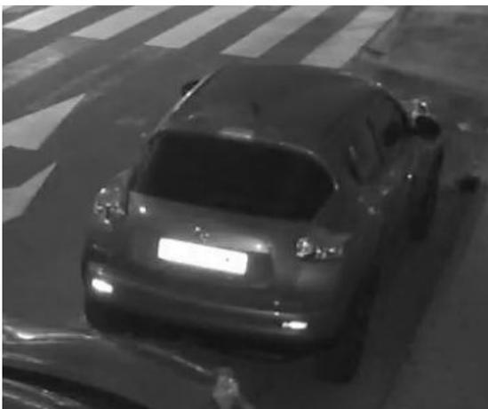
Abb. 14: Überbelichtete Kennzeichen aufgrund zu starken IR-LED-Lichts
