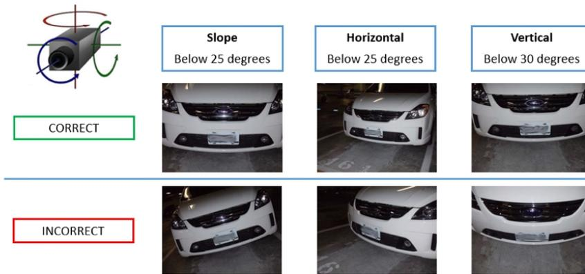
Abb. 10: Maximaler Drehungswinkel
