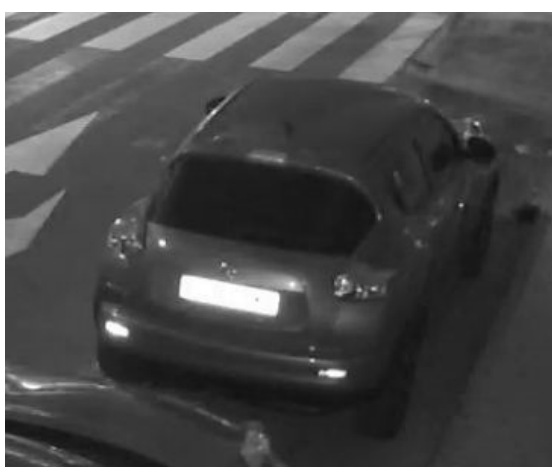
Fig. 14: Plaques d'immatriculation surexposées à cause d'une LED IR trop forte
