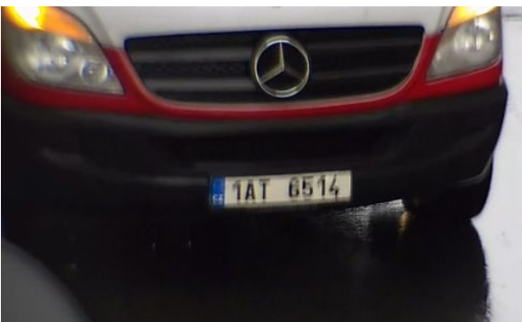
Abb. 12: Unscharfes Kennzeichen aufgrund langer Belichtungszeit
