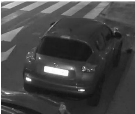
Abb. 14: Überbelichtete Kennzeichen aufgrund zu starken IR-LED-Lichts
