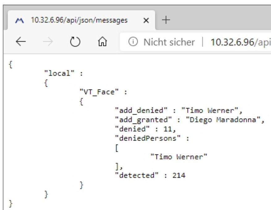
Fig. 18: Exemple : Métadonnées transmises dans un message MxMessage de Visage Technologies Face Recognition App
