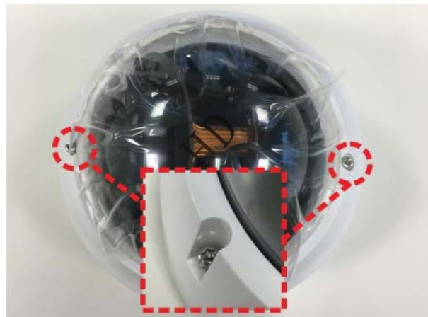
2. Aprire il blocco di ingresso del condotto posteriore con una moneta e posizionarlo sull'ingresso del condotto laterale.
