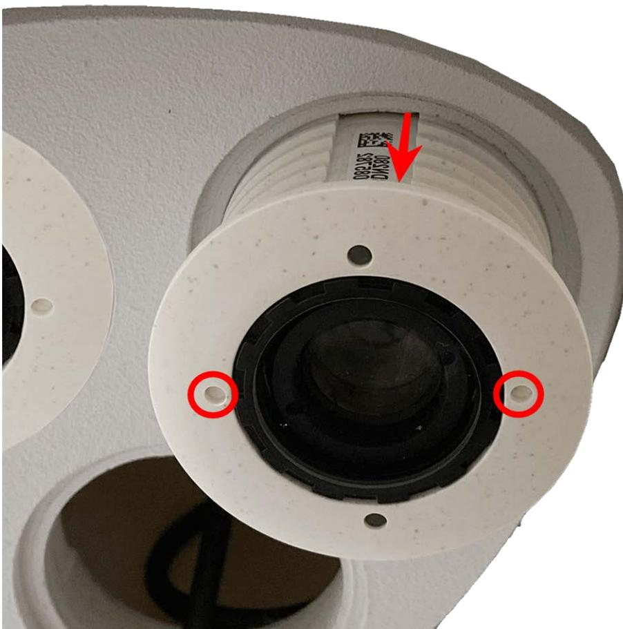
Abb. 23: Sensormodul aus Modulgehäuse entfernen
