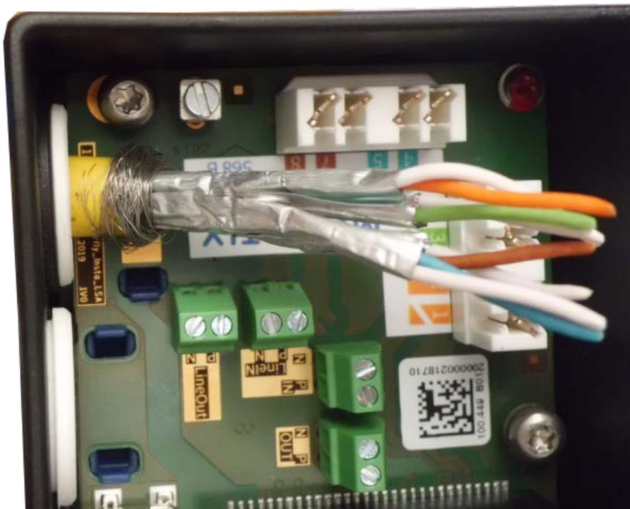
**Abb. 60: Netzwerkkabel eingesteckt, Stopfen richtig eingesetzt**
