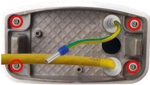
Abb. 58: Montageplatte mit Masseleitung und Netzwerkkabel
