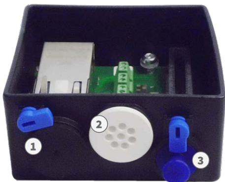
Abb. 31: Anschlussbox RJ45
