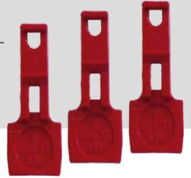
Die Sicherheitsclips schützen die Sensormodule bzw. das Blindmodul in der Frontplatte der M73 vor Diebstahl und unerwünschtes Verdrehen (z. B. durch Schwingungen bei Mastmontage oder in Kfz). Wenn sie installiert sind, müssen Sie sie entfernen, bevor Sie die Sensormodule entfernen können.
