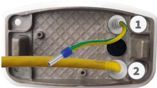
Abb. 49: Montageplatte mit Masseleitung und Netzwerkkabel
