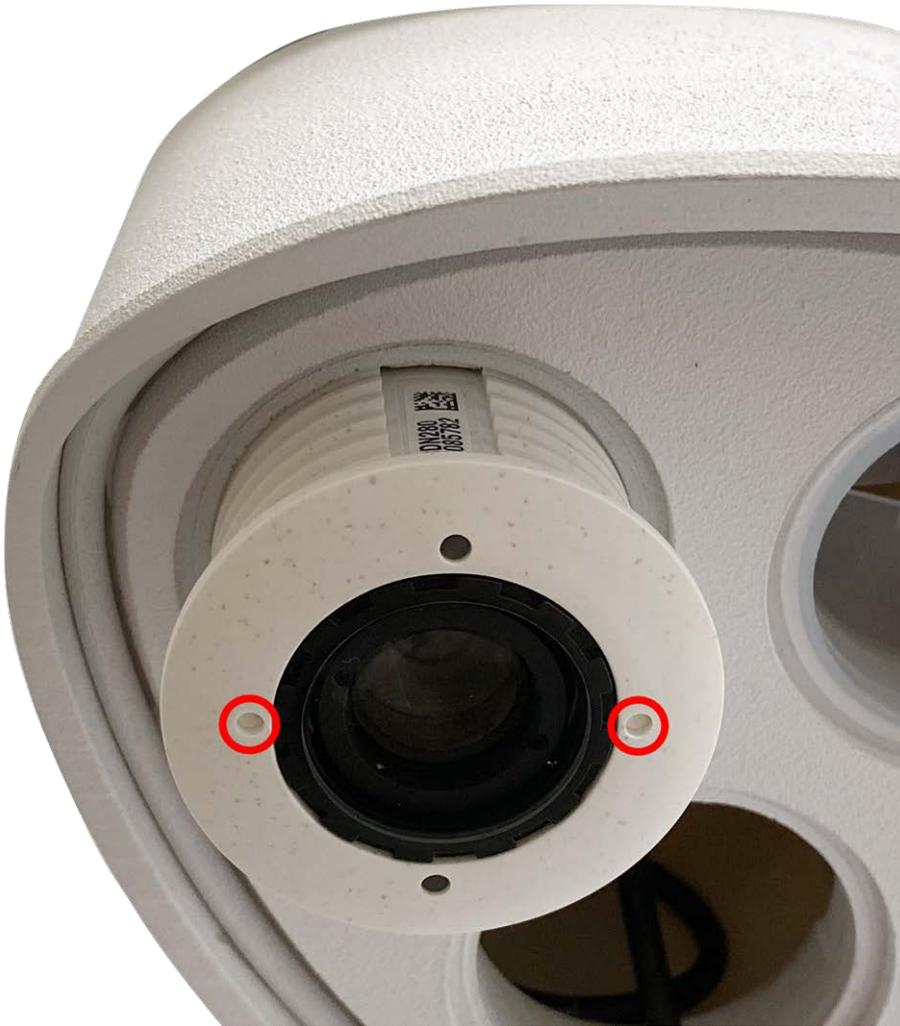
**Abb. 12: Sensormodul in Modulgehäuse einsetzen**
