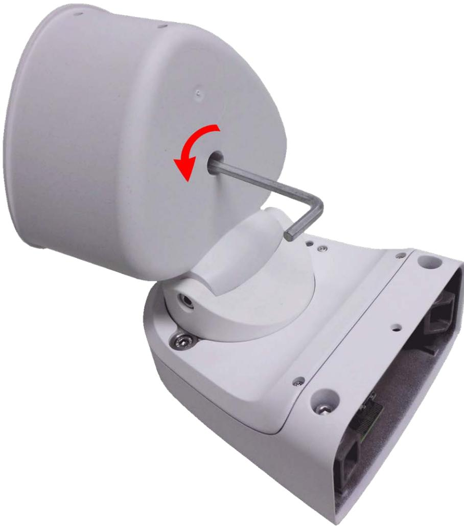
**Abb. 14: Modulgehäuse öffnen**
