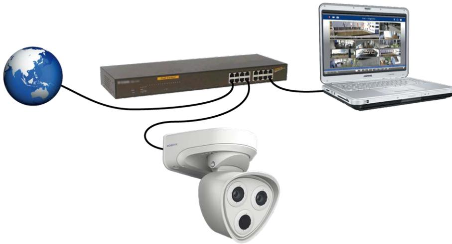
Abb. 52: Stromversorgung per PoE-Switch gemäß PoE Plus (802.3at-2009)
