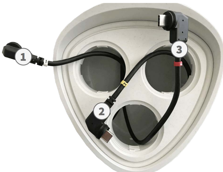
Fig. 8: Câbles du module de capteur numérotés
