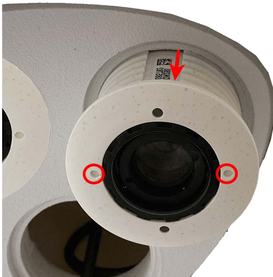
Fig. 23: Retirez le module de capteur du boîtier du module
