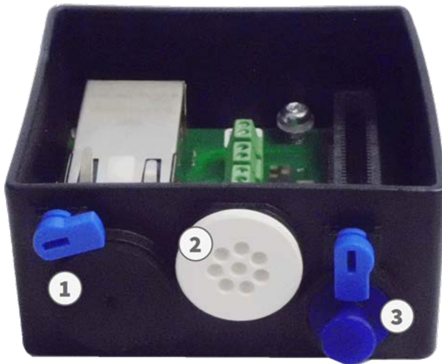
Fig. 53: Boîtier de connexion RJ45 avec bouchon en caoutchouc noir C.3 (1), bouchon en caoutchouc à un fil C.4 (2), prise USB (3) et deux verrous bleus
