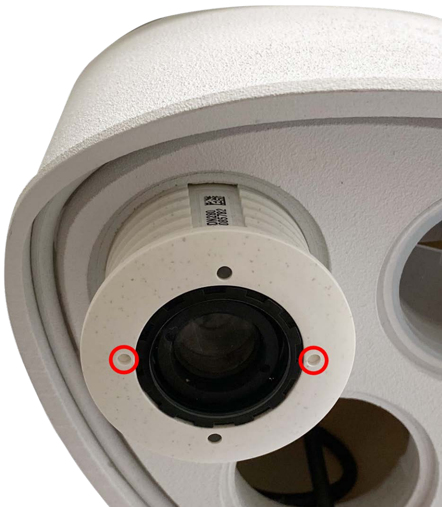
Fig. 22: Déverrouillez le module de capteur
