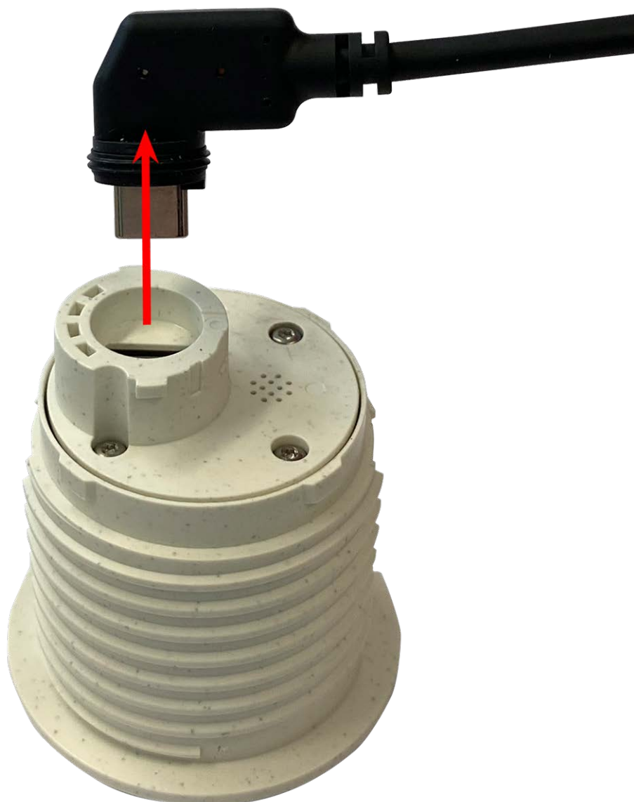
Fig. 21: Retirez le câble du module de capteur
