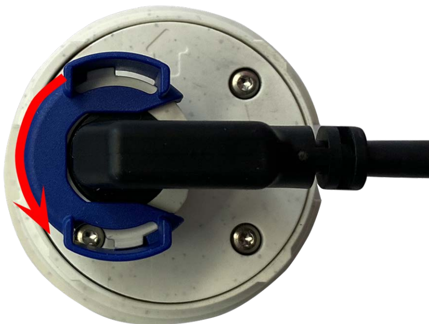
Fig. 20: Déverrouillez le câble du module de capteur
