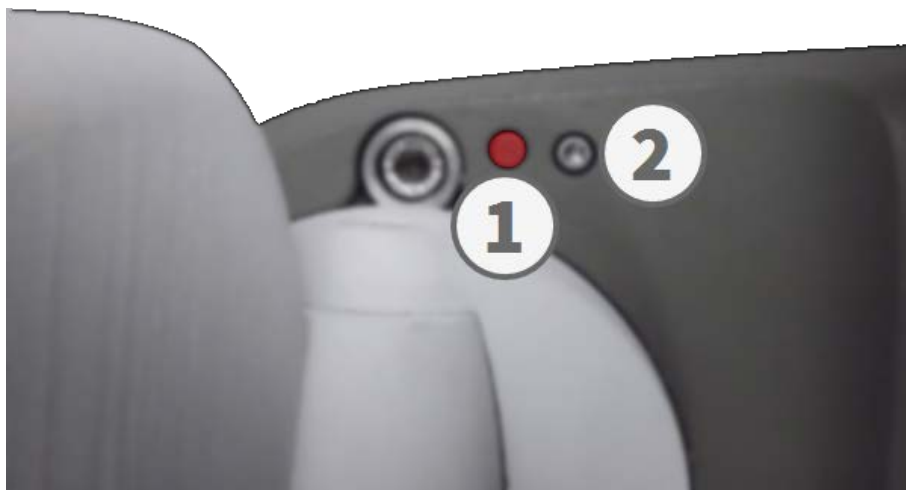
Fig. 74: Vue de la M73 du dessous avec voyant (1) et vis avec joint (2) qui masque la clé à l'intérieur du boîtier de la caméra
