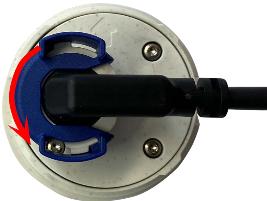
Fig. 20: Sbloccare il cavo del modulo sensore
