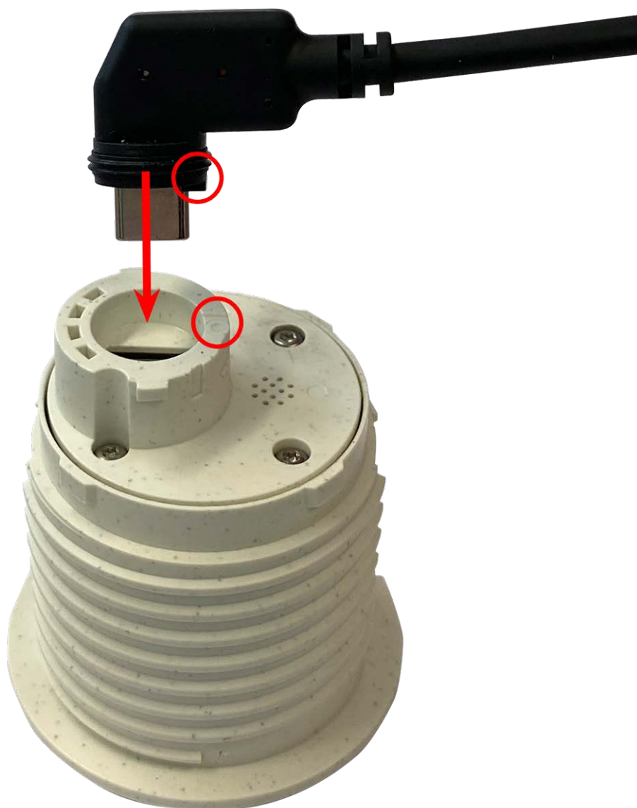
Fig. 27: Collegare il cavo del modulo sensore
