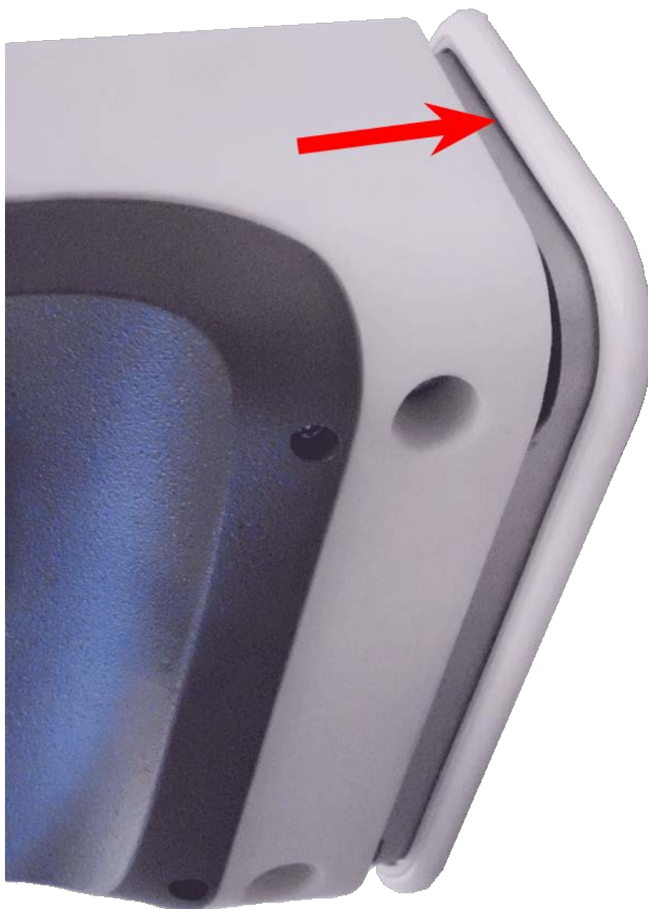
Fig. 69: Premere la telecamera sulla piastra di montaggio
