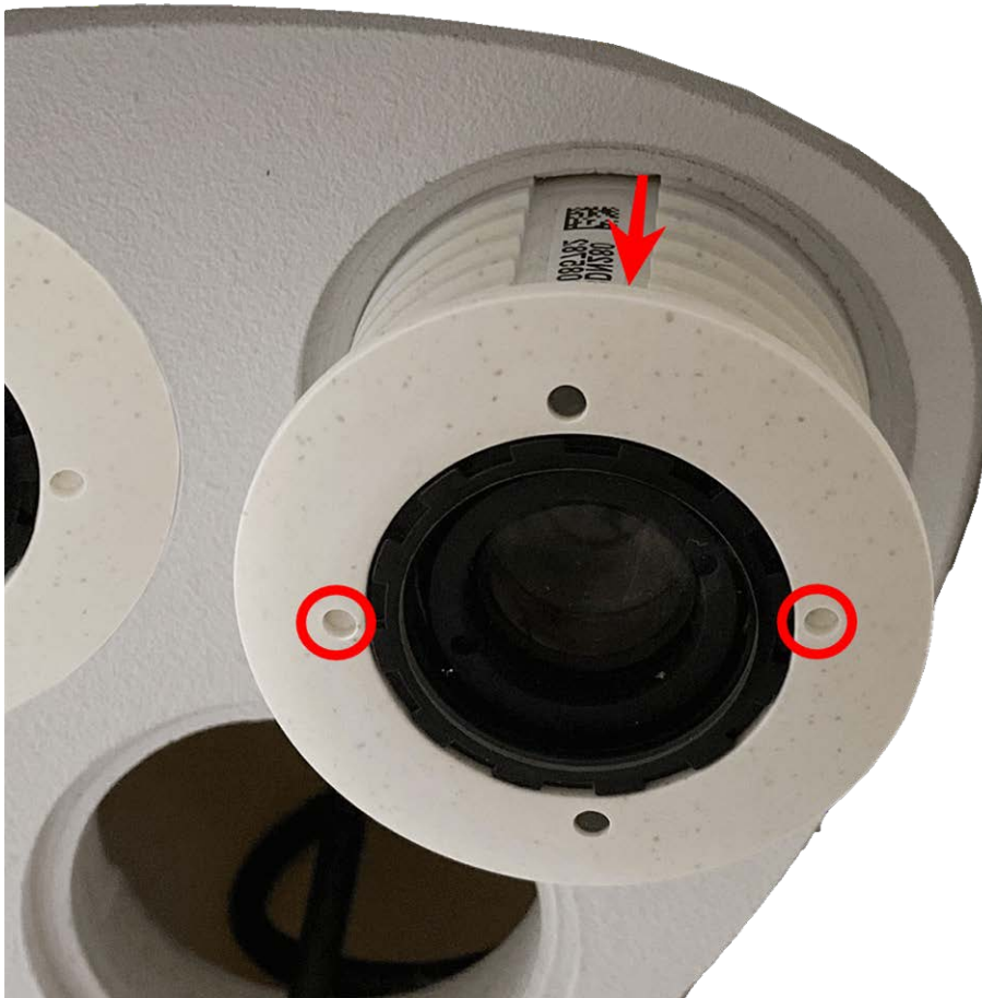
Fig. 23: Rimuovere il modulo sensore dall'alloggiamento del modulo
