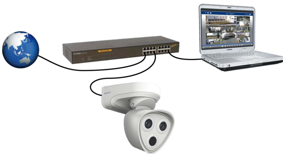
Fig. 52: Alimentazione tramite interruttore PoE in base allo standard PoE Plus (802.3at-2009)
