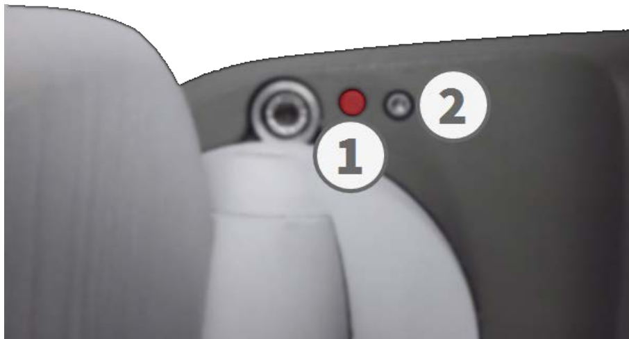
Fig. 74: Vista della M73 dal basso con LED (1) e vite con guarnizione (2) che nasconde il tasto all'interno del corpo della telecamera
