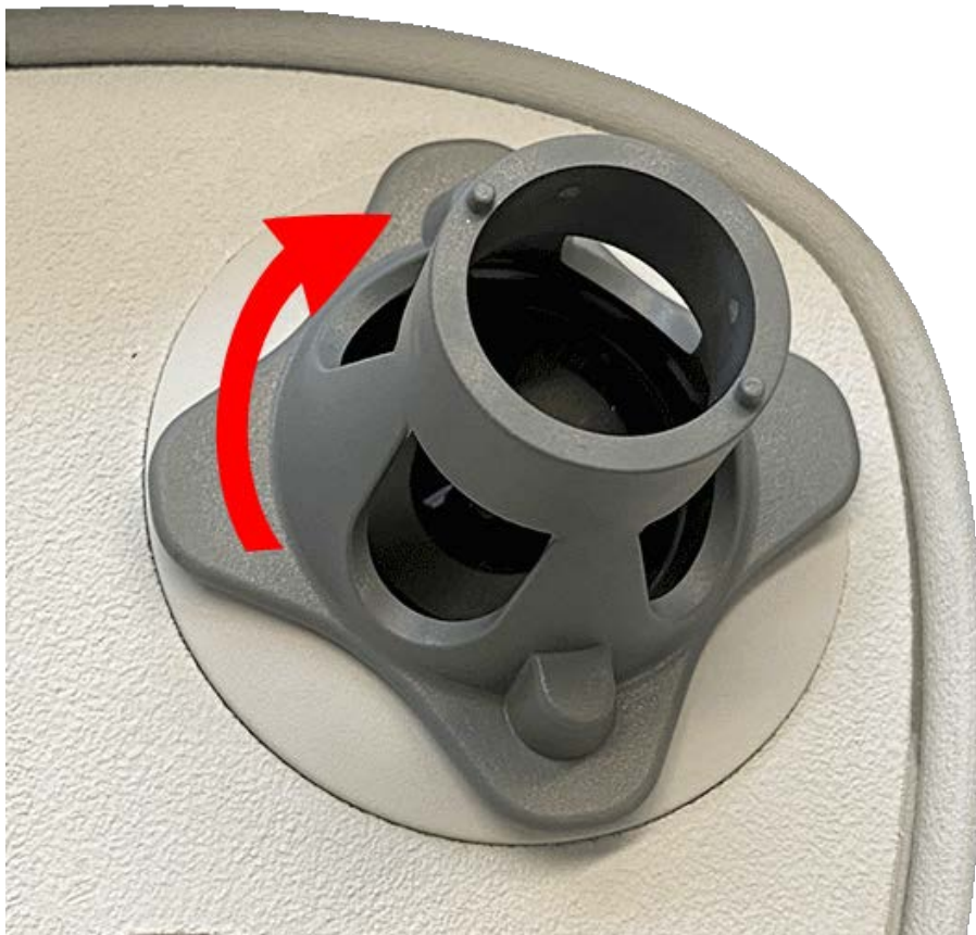
Fig. 26: Bloccare il modulo sensore
