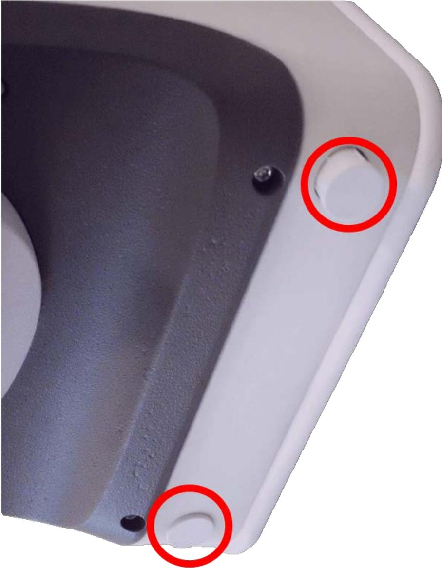
**Fig. 71: Apply rubber plugs**
