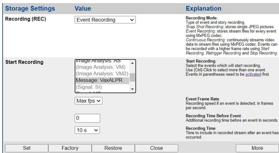
Fig. 27: Configuration des paramètres d'enregistrement de la caméra
