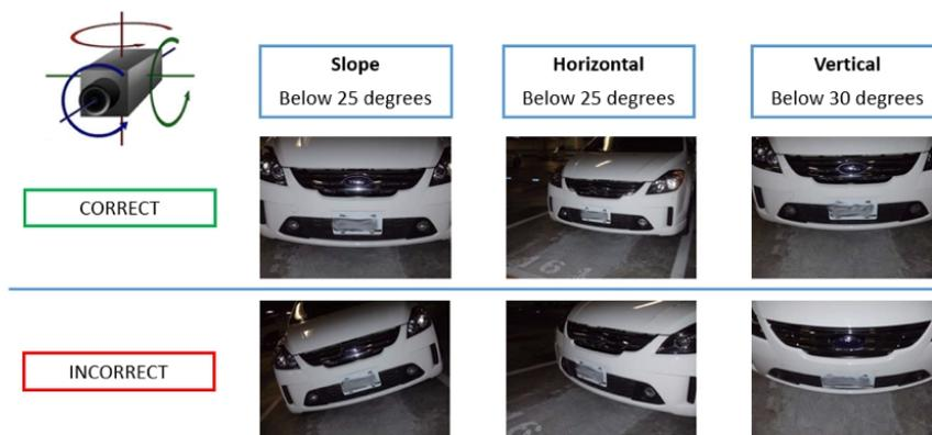
Fig. 10: Angle de rotation maximal
