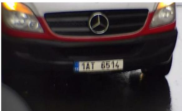
Abb. 12: Unscharfes Kennzeichen aufgrund langer Belichtungszeit
