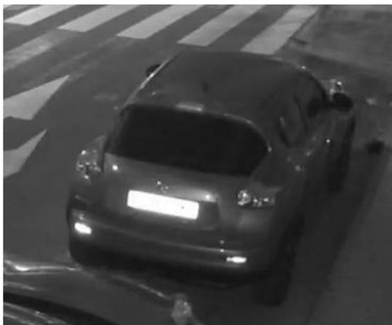
Fig. 14: Matrícula sobreexpuesta debido a luz LED IR demasiado intensa
