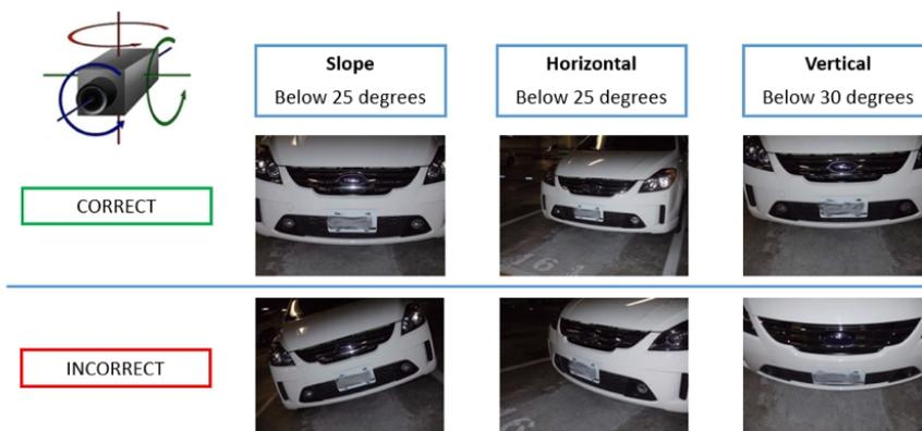
Fig. 10: Ángulo de rotación máximo
