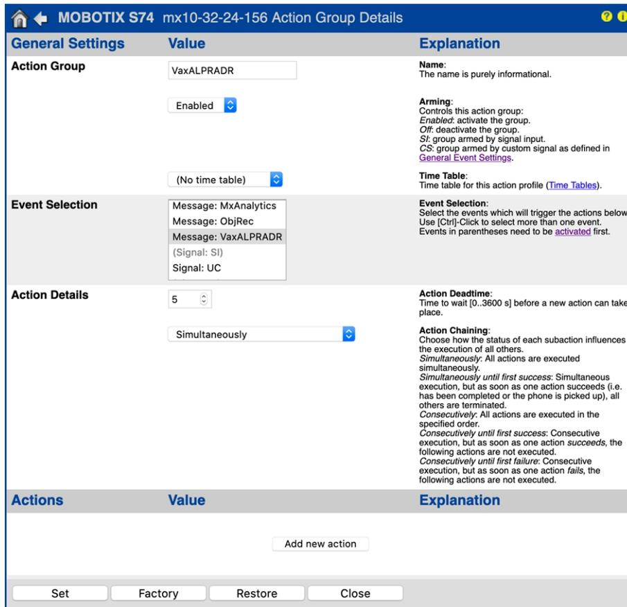
Fig. 23: Configurazione di un gruppo di azioni
