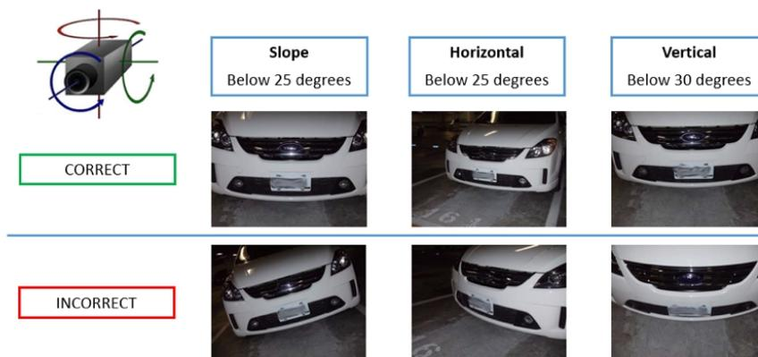
Fig. 10: Angolo di rotazione massimo
