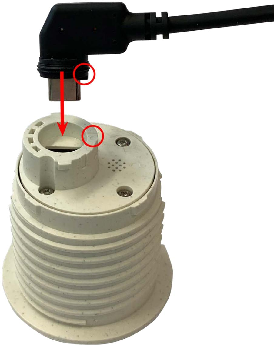
**Fig. 8: Anschließen des Sensormodulkabels**
