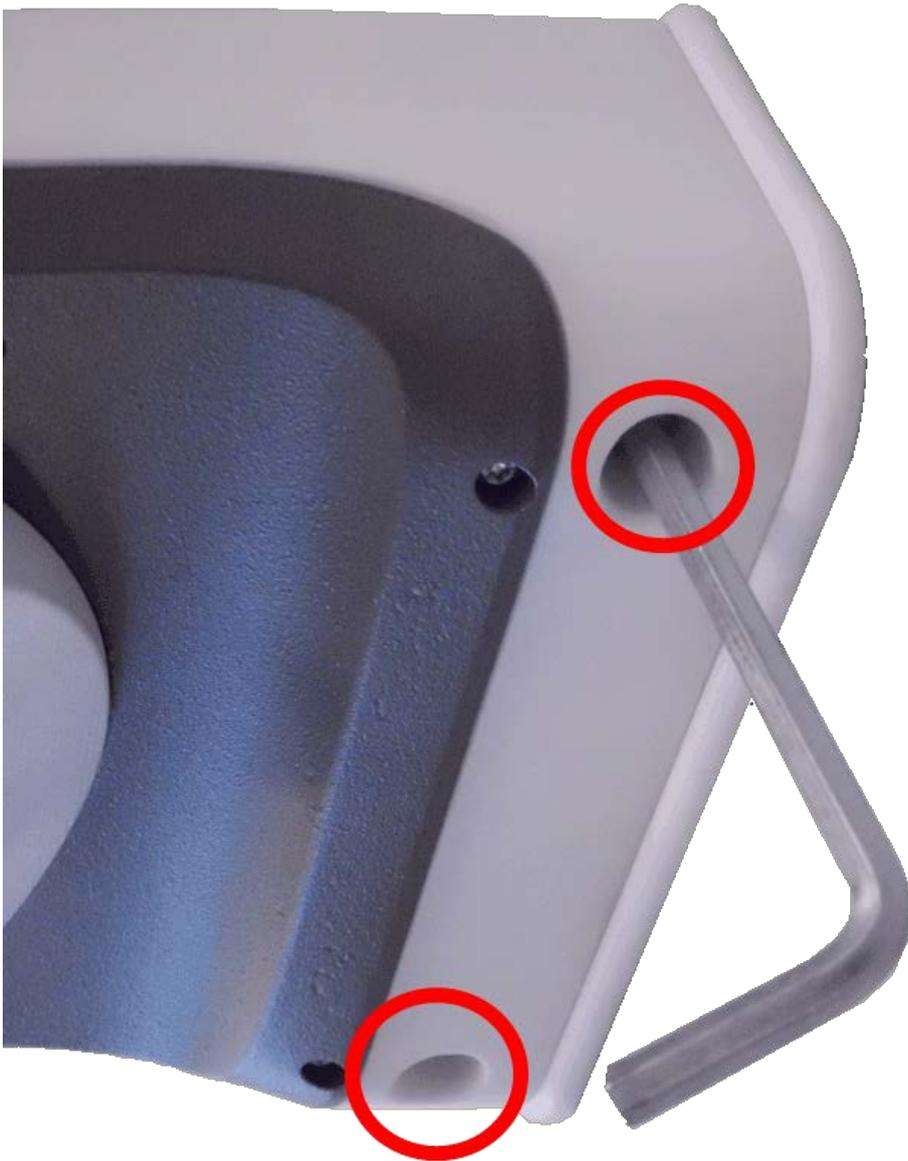
**Fig. 69: Innensechskantschrauben festziehen**
