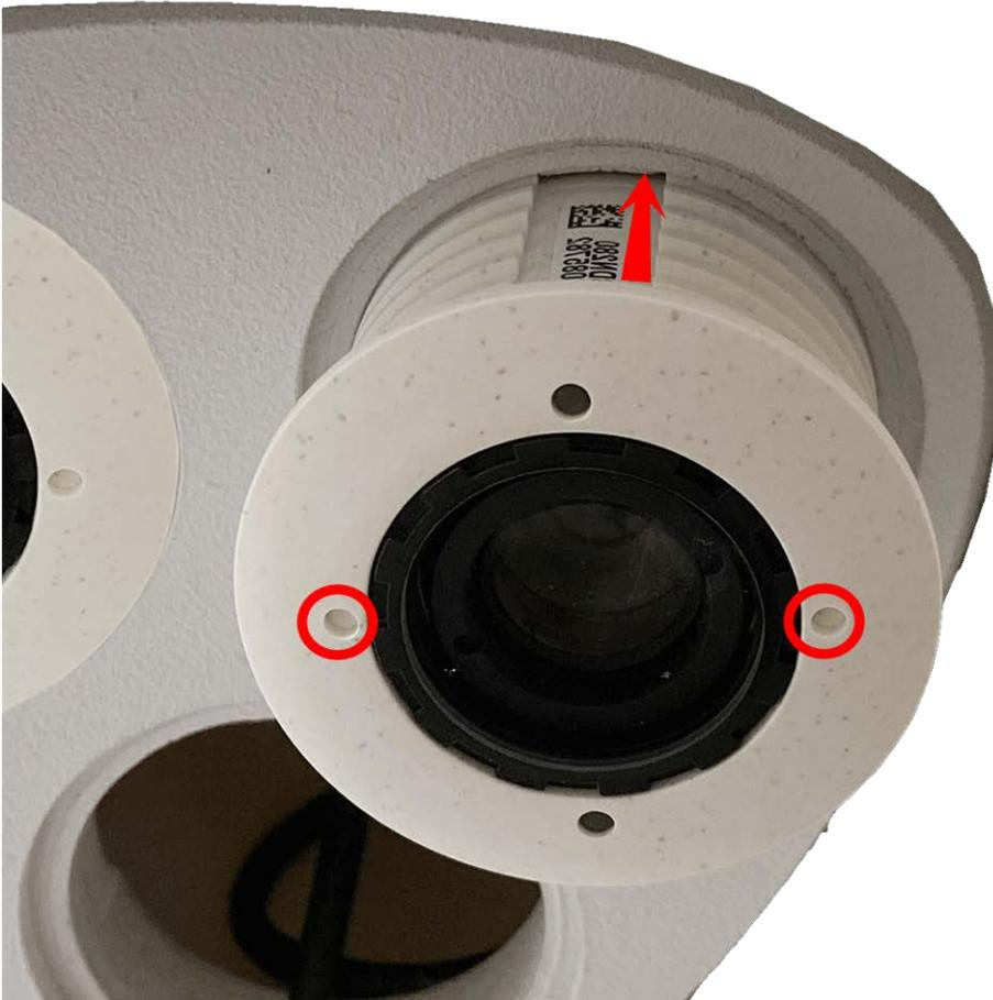
Fig. 24: Sensormodul in Thermal-Frontplatte einsetzen
