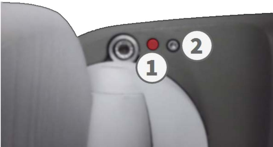
Fig. 73: Ansicht der M73 von unten mit LED ① und Schraube mit Dichtung ②, die die Taste im Kameragehäuse verbirgt
