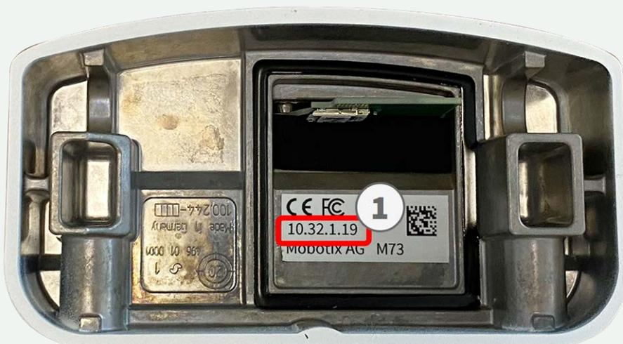
Fig. 4: IP-Adresse auf der Rückseite des Kameragehäuses
