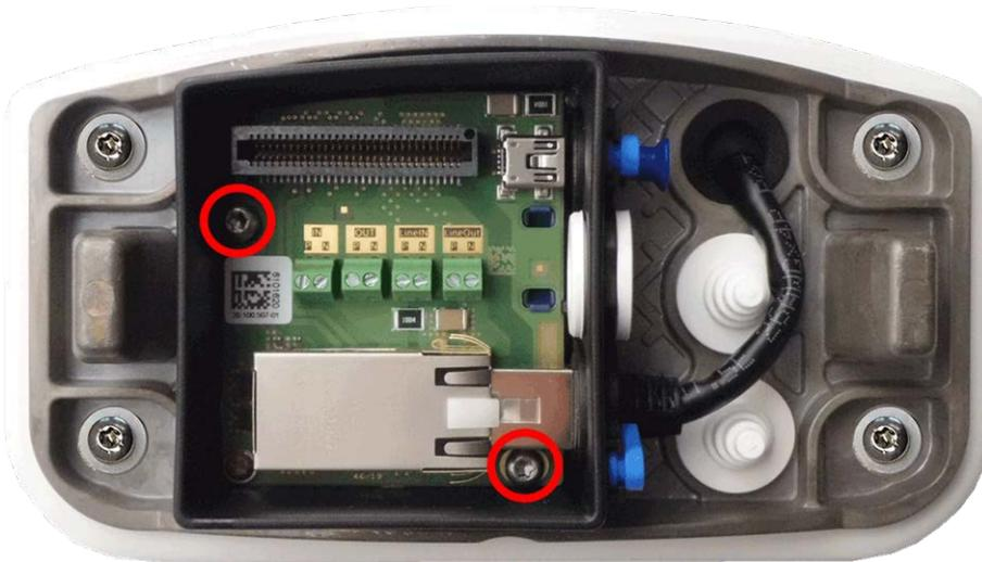
Fig. 54: Anschlussbox RJ45 (Draufsicht) mit zwei Schrauben (rot hervorgehoben) an Montageplatte montieren
