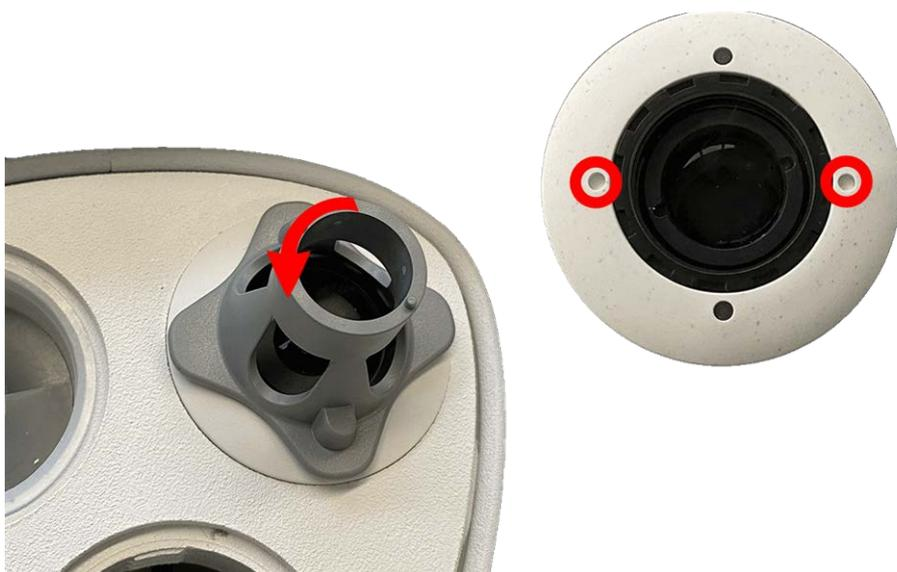
Fig. 21: Sensormodul entriegeln
