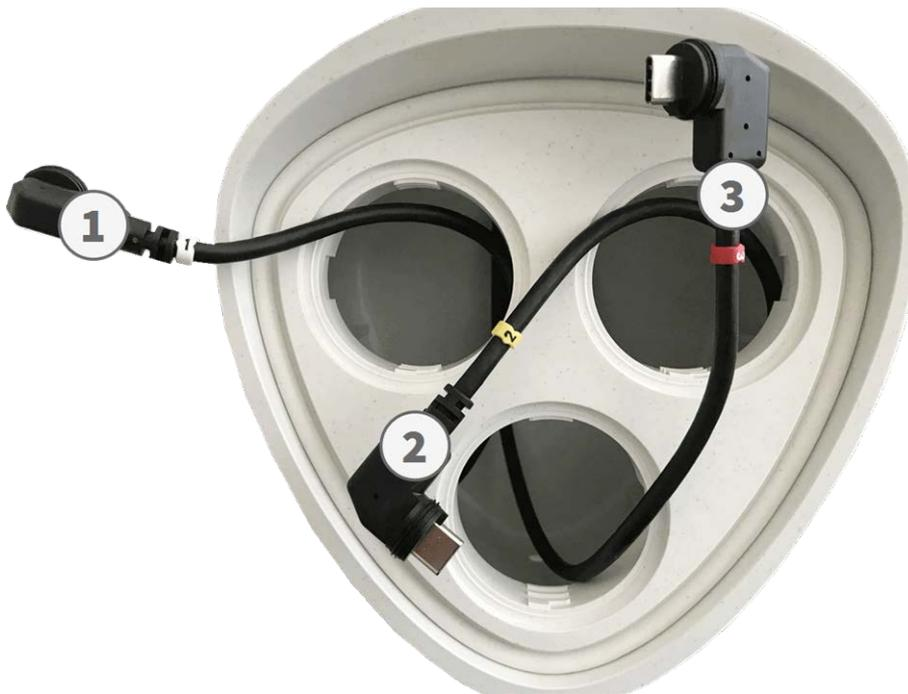
Fig. 7: Nummerierte Sensormodulkabel
