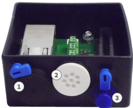
Fig. 30: Anschlussbox RJ45
