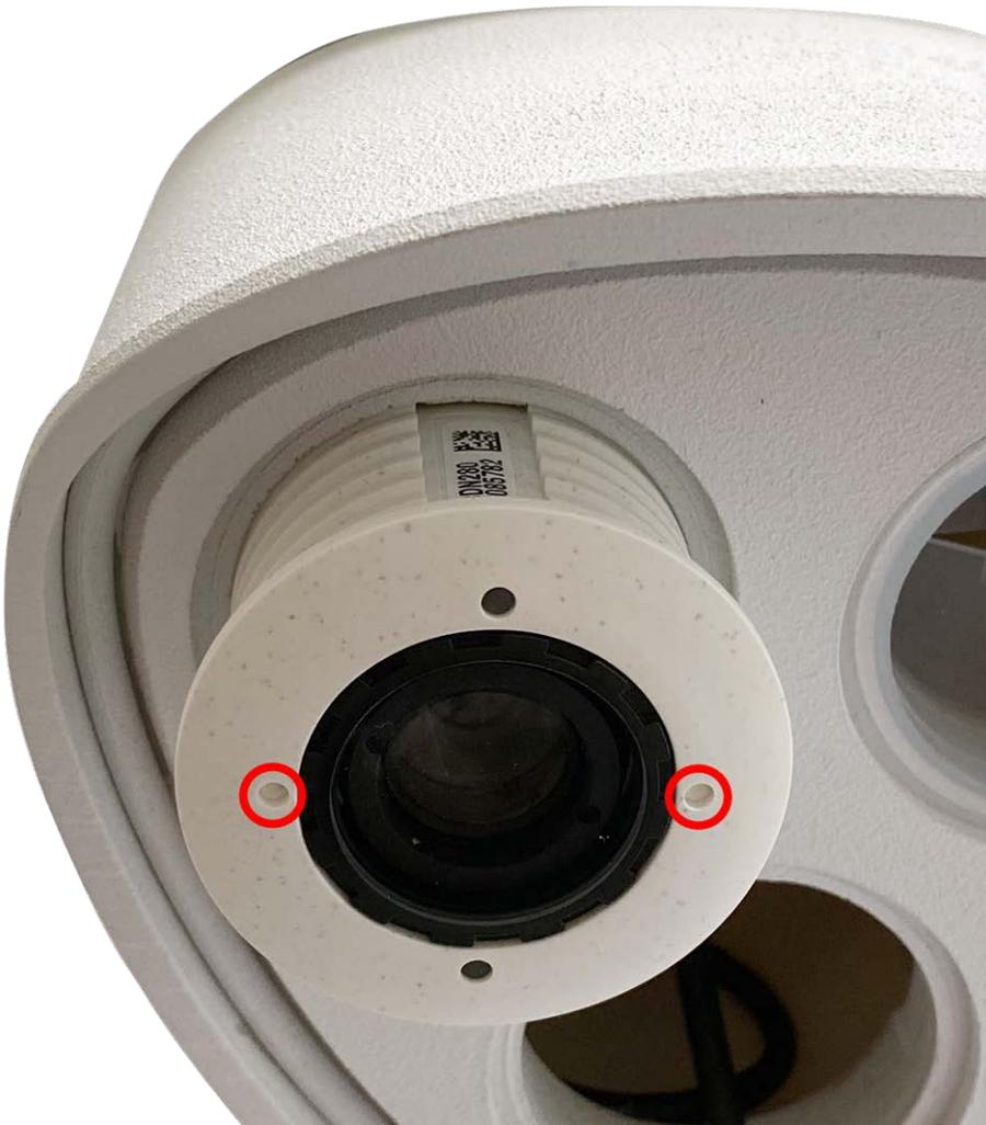
Fig. 11: Sensormodul in Modulgehäuse einsetzen
