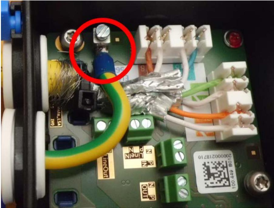
Fig. 65: Masseleitung mit Klemme verbunden
