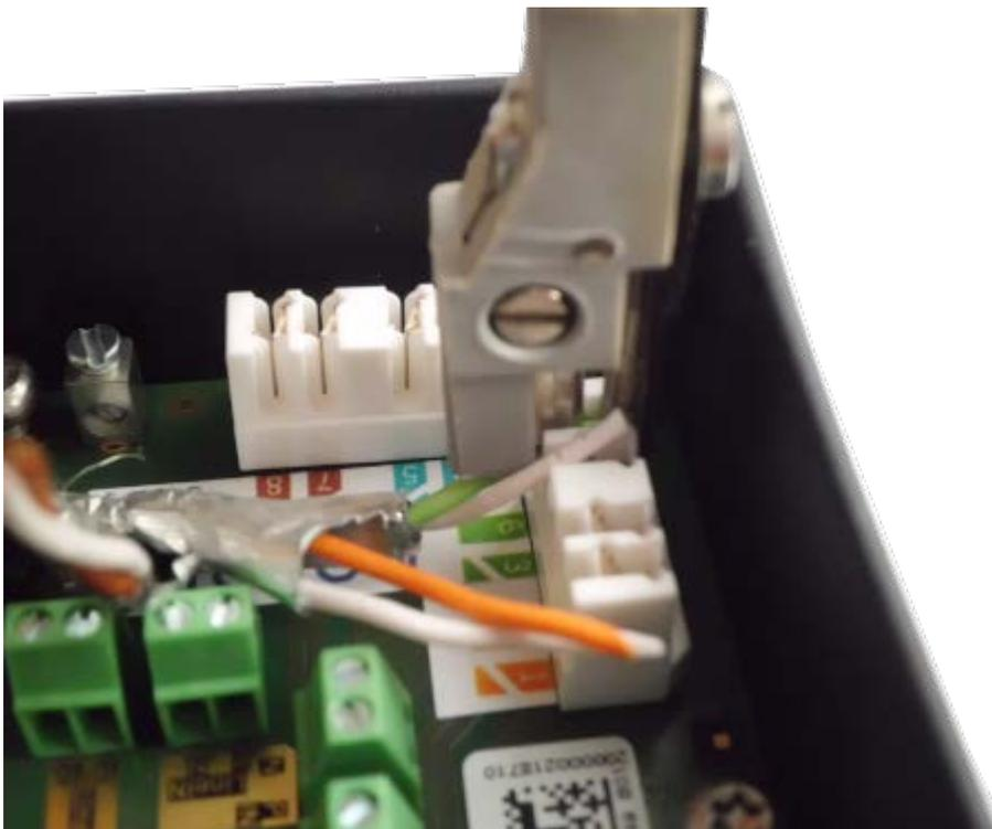
Fig. 62: Mit Krone LSA-Plus-Anlegewerkzeug angeschlossenes Netzkabel
