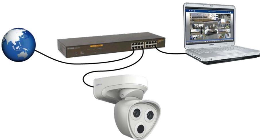
Fig. 51: Stromversorgung über PoE-Switch gemäß PoE Plus (802.3at-2009)
