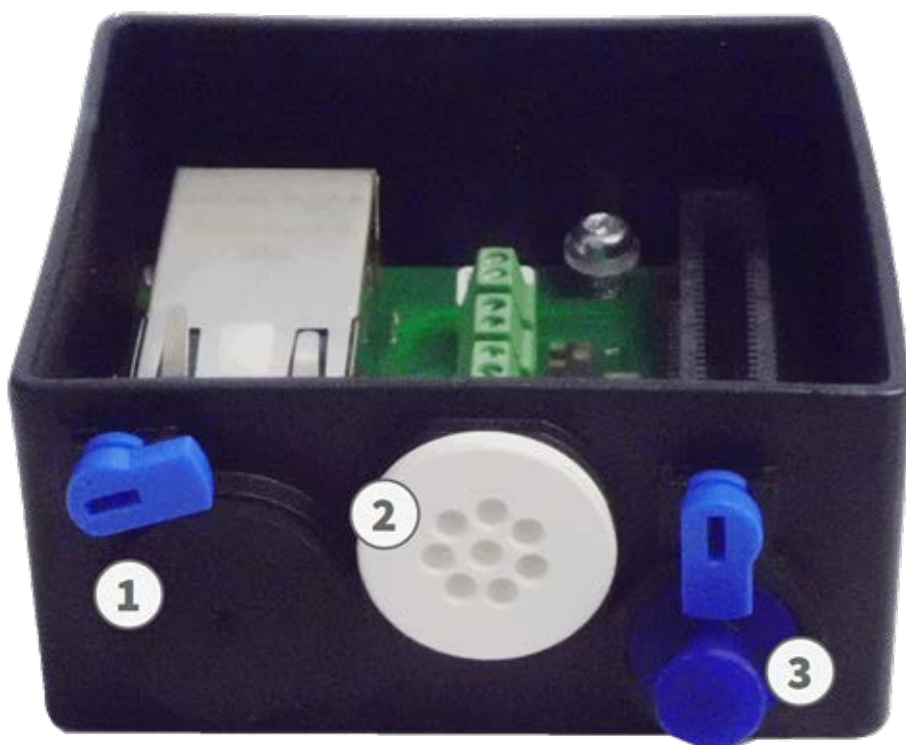
Fig. 53: Boîtier de connexion RJ45 avec bouchon en caoutchouc noir C.3 ①, bouchon en caoutchouc à un fil C.4 ②, prise USB ③ et deux verrous bleus
