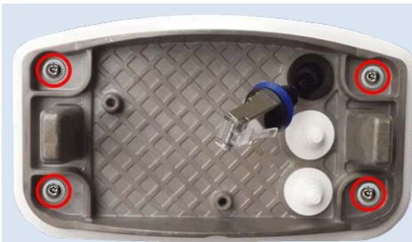
Fig. 50: Installé et prêt pour Boîtier de connexion RJ45
