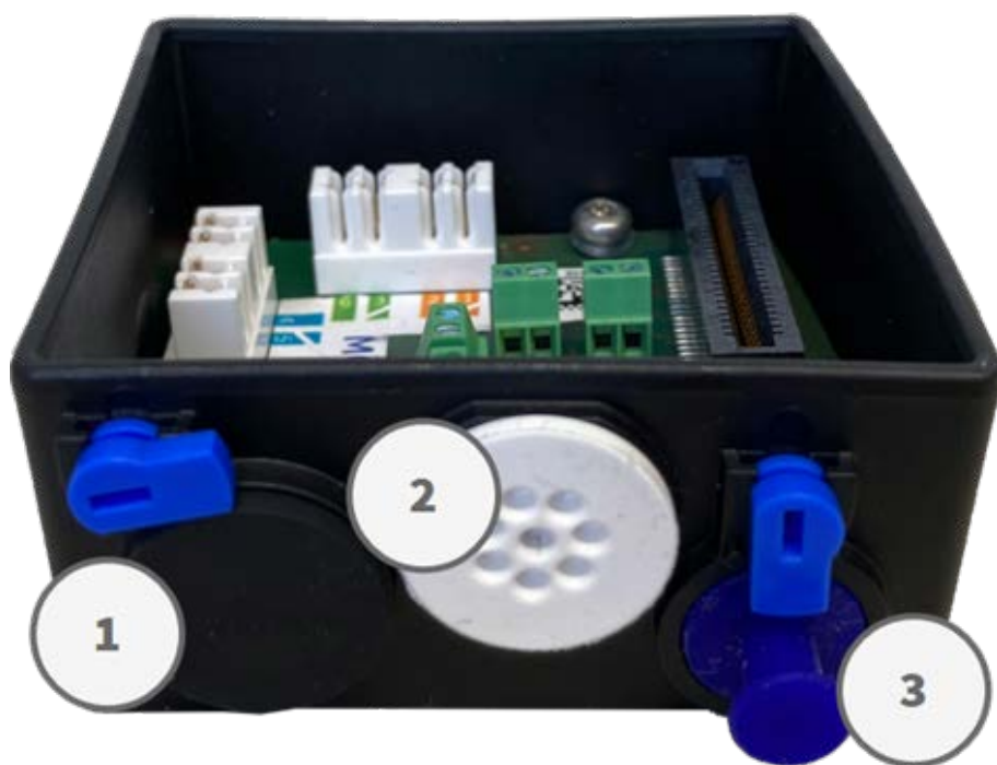
Fig. 56: Boîtier de connexion LSA avec bouchon en caoutchouc noir C.3 ①, bouchon en caoutchouc à un fil C.4 ②, prise USB ③ et deux verrous bleus
