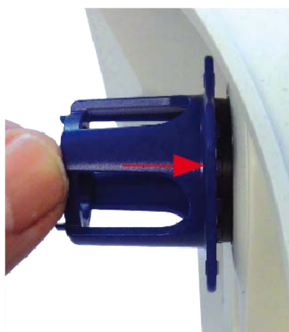
Fig. 87: Appuyez fermement pour insérer le verre de protection de l'objectif et tournez pour le verrouiller
