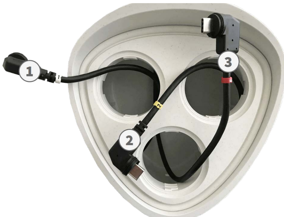
Fig. 8: Câbles du module de capteur numérotés
