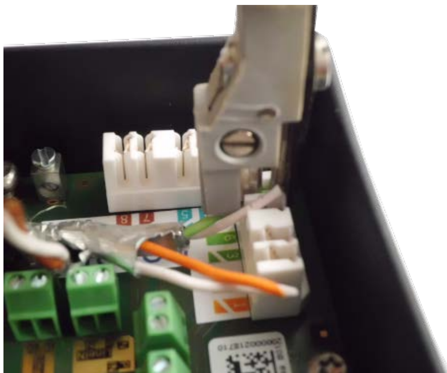
Fig. 63: Fils réseau connectés à l'aide de l'outil LSA+/Krone
