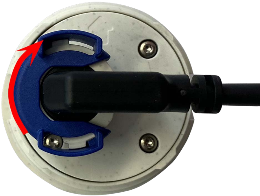
Fig. 11: Bloquez le module de capteur
