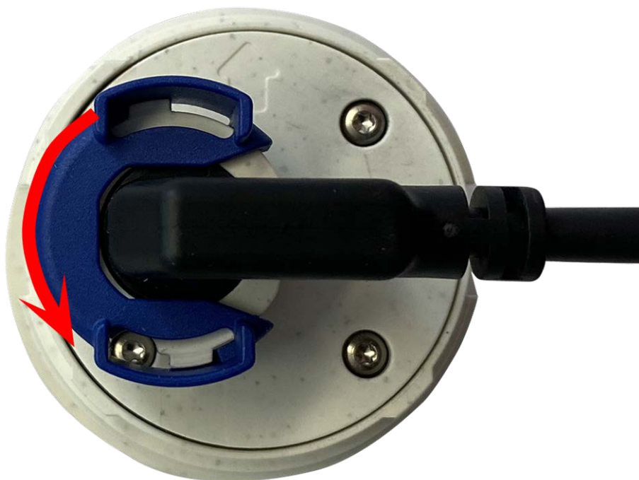
Fig. 20: Déverrouillez le câble du module de capteur
