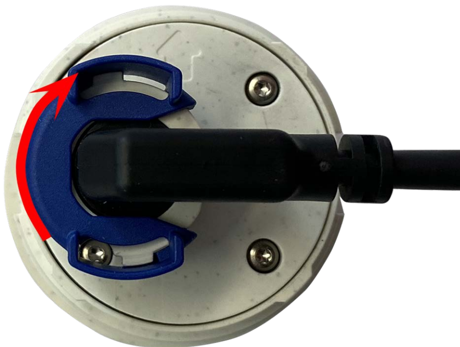
Fig. 28: Blocage du câble du module de capteur
