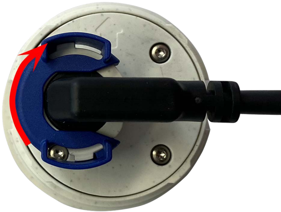
Fig. 28: Lock sensor module cable
