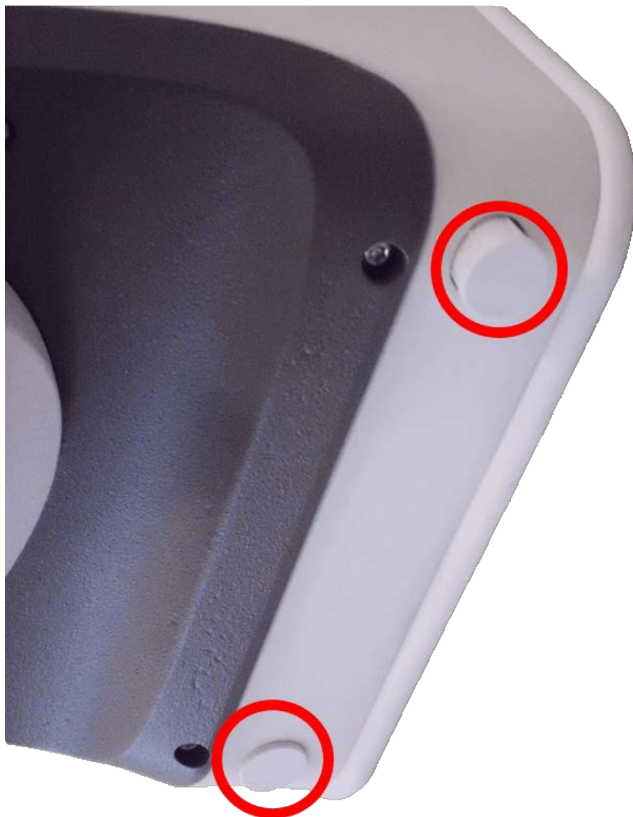
Fig. 91: Remove rubber plugs
