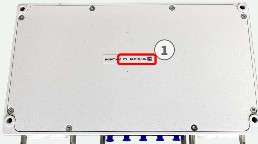
Abb. 8: IP-Adresse auf der Rückseite des Kameragehäuses
