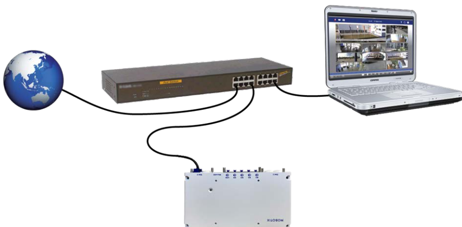
Abb. 34: Stromversorgung über PoE-Switch gemäß PoE Plus (802.3at-2009)
