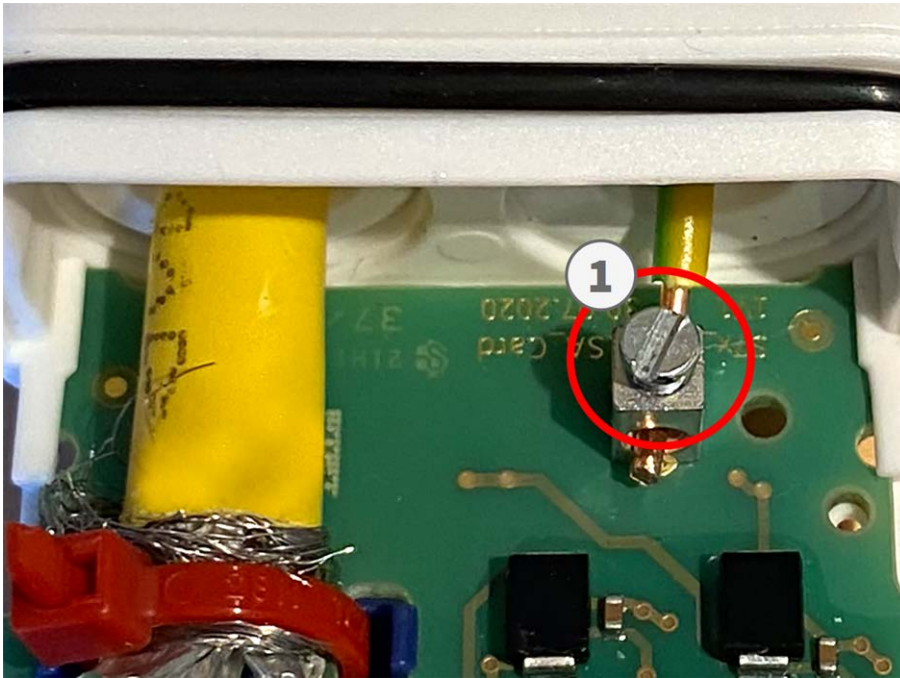
Abb. 29: Masseleitung mit Klemme verbunden
