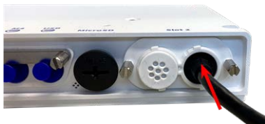
Abb. 35: Drücken Sie den Stecker fest ein, bis der blaue Dichtring einrastet.
