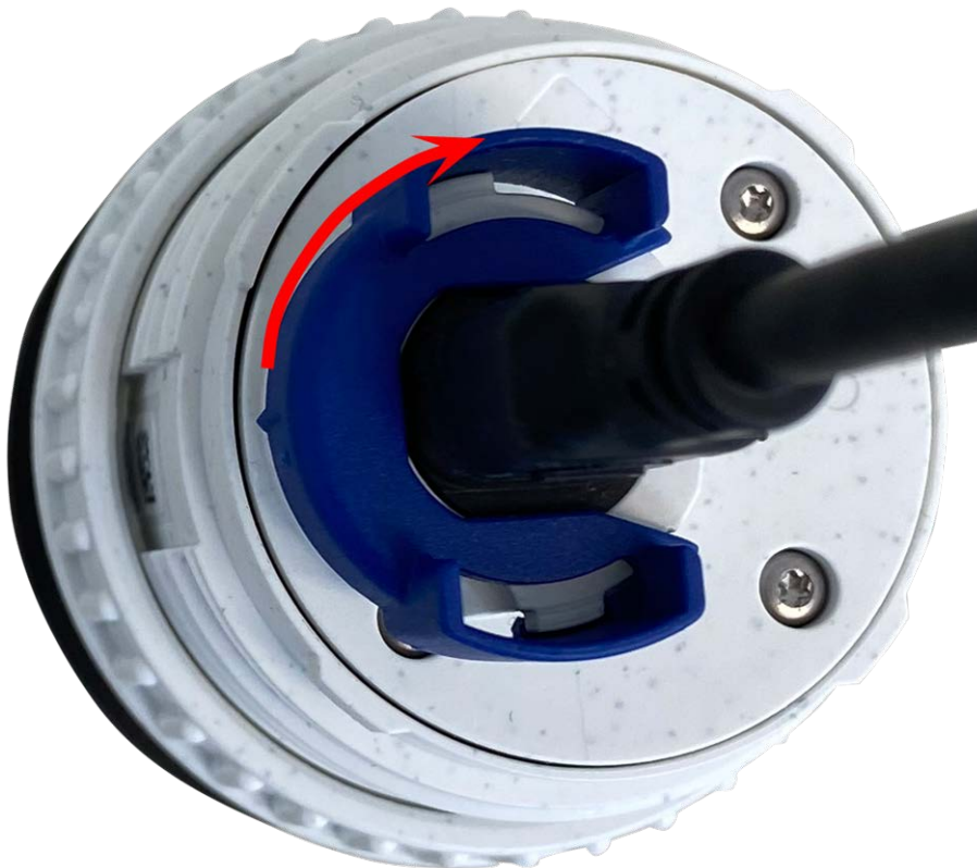
Fig. 12: Bloquee el cable del módulo del sensor
