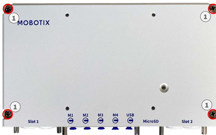
Fig. 31: Placa de montaje instalada en la pared
