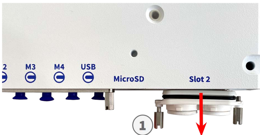
Fig. 22: Retire la cubierta de la ranura de la tarjeta de interfaz
