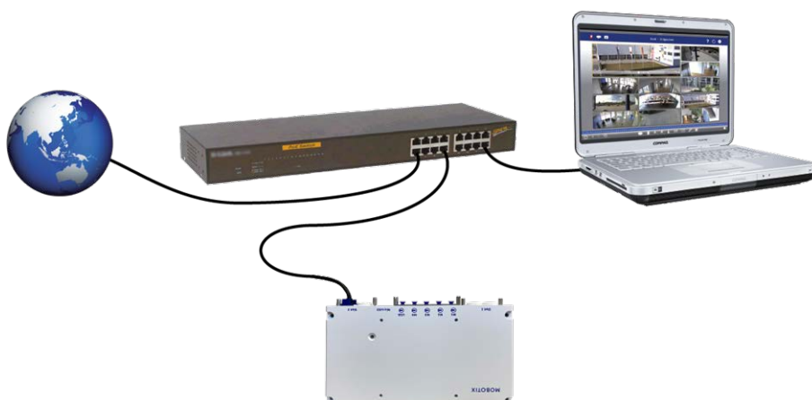
Fig. 34: Fuente de alimentación mediante un conmutador PoE según la PoE Plus (802.3at-2009)
