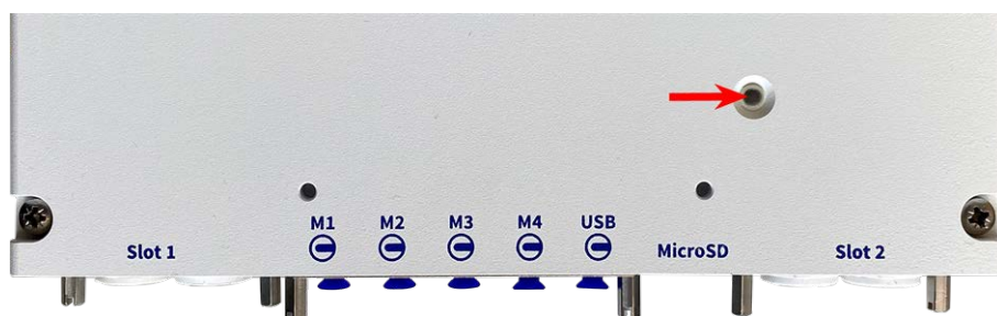
Fig. 36: LED de la cámara en la parte superior del chasis de la cámara
