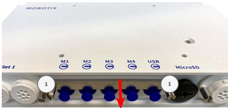
2. Déposez le bouchon en caoutchouc bleu ① du connecteur de module.
