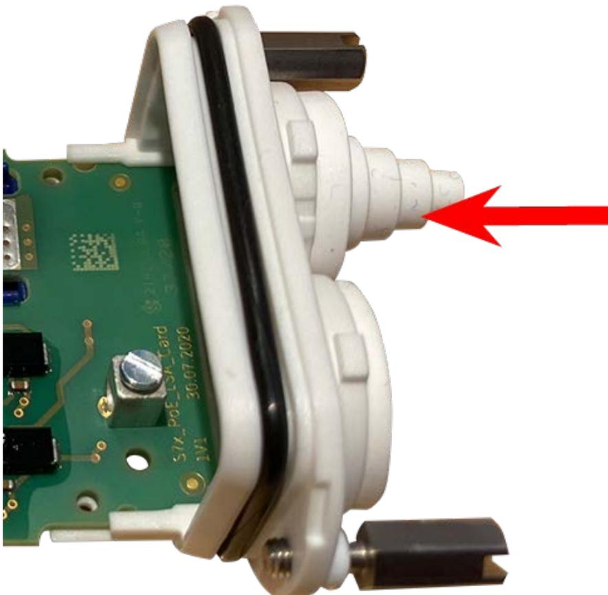
3. Insérez le câble réseau dans le bouchon en caoutchouc blanc :
