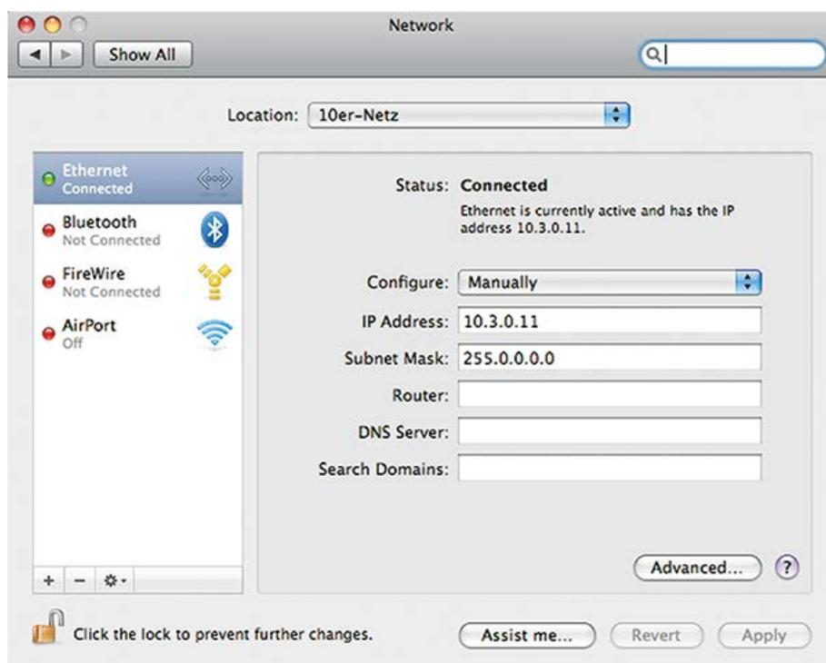
Fig. 39: Paramètres réseau sur des ordinateurs macOS
