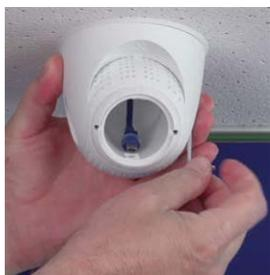
7. Desserrez les deux vis de fixation de l'insert ①, puis faites tourner l'insert de sorte que la petite barre située à l'opposé de l'étiquette **TOP/OBEN** soit orientée vers le trou de la vis sans tête ②.
