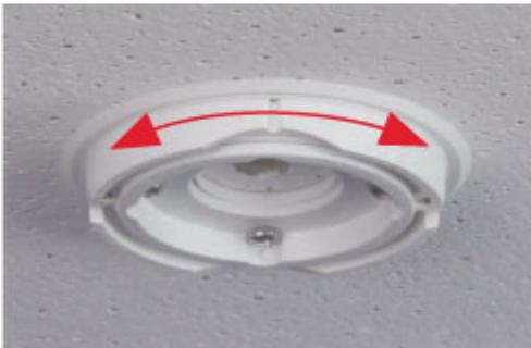
4. • Faites passer le câble du capteur à travers le joint, la bague rotative, le socle et la surface de montage jusqu'à la caméra.
