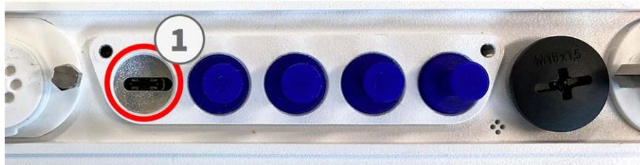
3. Branchez le câble du module sur le connecteur de module ① de manière à ce que la petite fiche ② mâle s'insère dans le connecteur de module.
