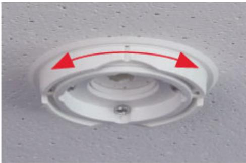
4. • Far passare il cavo sensore attraverso la guarnizione, l'anello girevole, la piastra di base e attraverso la superficie di montaggio fino alla telecamera.
