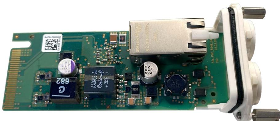
Fig. 17: Scheda di interfaccia RJ45
