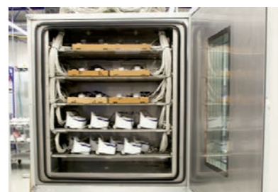
Antes de la entrega se comprueba la resistencia a temperaturas extremas de la cámara.
