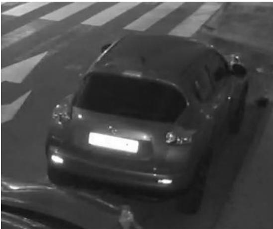
Abb. 14: Überbelichtete Kennzeichen aufgrund zu starken IR-LED-Lichts
