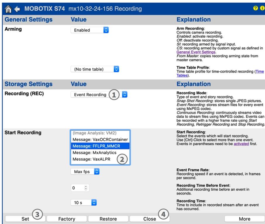
**Abb. 29: Konfiguration der Aufnahmeeinstellungen der Kamera**
