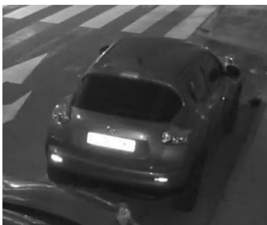
Fig. 14: Matrícula sobreexpuesta debido a luz LED IR demasiado intensa
