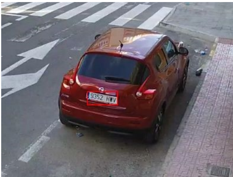
Fig. 16: Luz insuficiente para reconocer la matrícula
