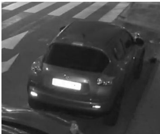
Fig. 14: Plaques d'immatriculation surexposées à cause d'une LED IR trop forte
