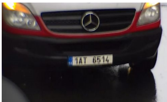
Fig. 12: Plaque d'immatriculation floue à cause d'une longue durée d'exposition
