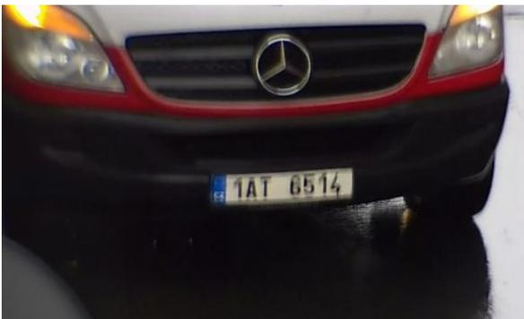
**Fig. 12: Targa sfocata a causa di un tempo di esposizione lungo**
