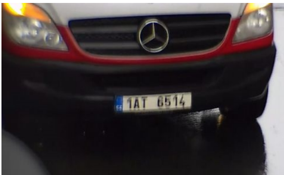
Fig. 14: Unscharfes Kennzeichen aufgrund langer Belichtungszeit
