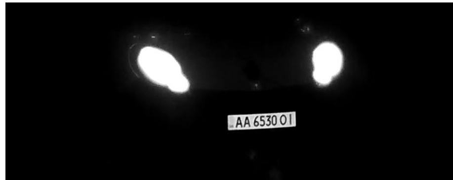
Fig. 10: Gut lesbares Kennzeichen bei Nacht mit Infrarot-LED-Beleuchtung
